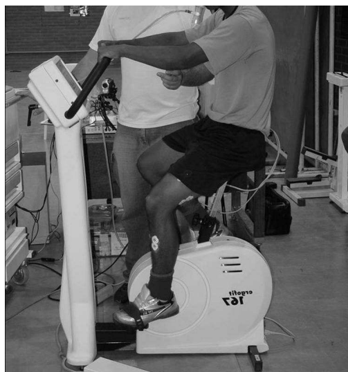
Figura 9 – Cicloergômetro computadorizado ERGOFIT modelo ERGOCYCLE 167 (ENRAF NONIUS, Sweden) utilizado para mensuração do VO_{2máx} .
