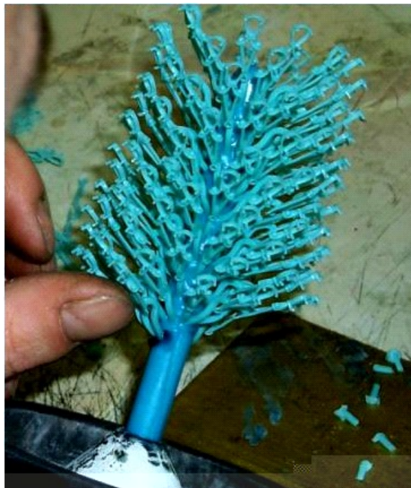
Figura 15: Fotografia dos modelos de cera montados em árvore [Hoben Internacional].
