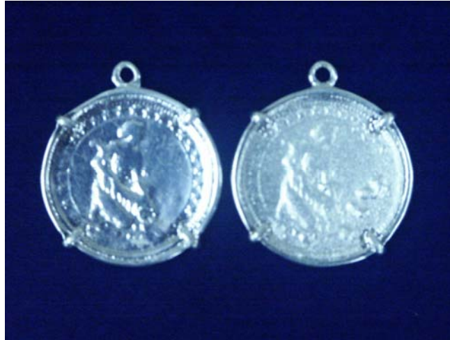
Figura 28: Exemplo de alta rugosidade superficial em uma jóia folhada confeccionada com a liga a base de Zn-Al-Cu-Mg e revestida com Prata.
