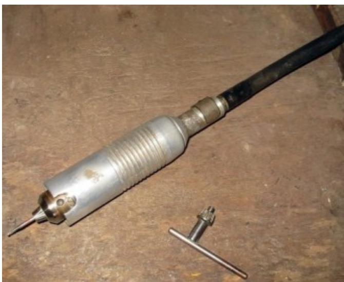
Figura 25: Chicote com mandril de cabo flexível [SALEM, 2000].
