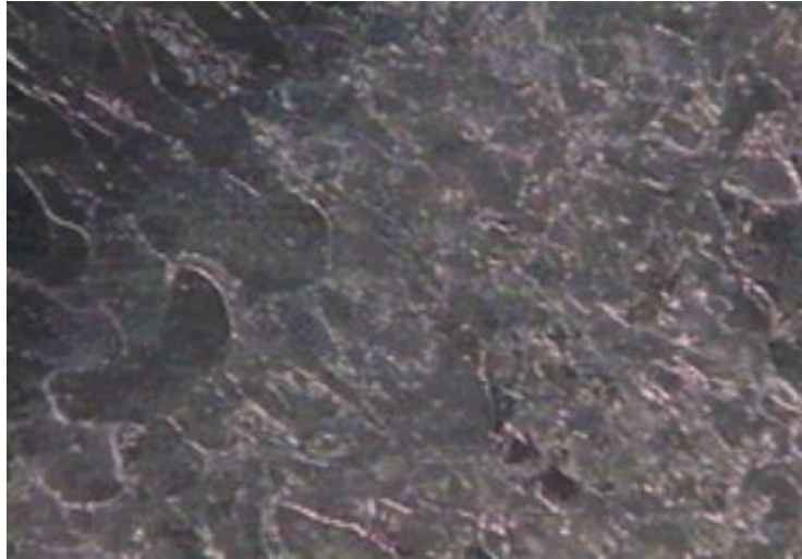
Figura 09: Exemplo de Marcas de Fluxo [CD DeZign, IZA].
