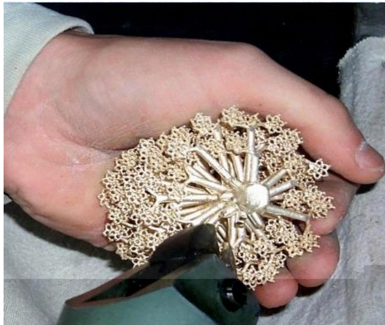
Figura 17: Fotografia ilustrando a etapa de separação das peças obtidas da árvore, no caso peças confeccionadas em Ouro [Hoben Internacional].
