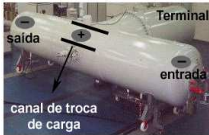
Figura 3.1: Foto do acelerador de partículas Tandem da UFRGS, indicando a posição do “stripper”, local onde ocorre a troca de carga.
