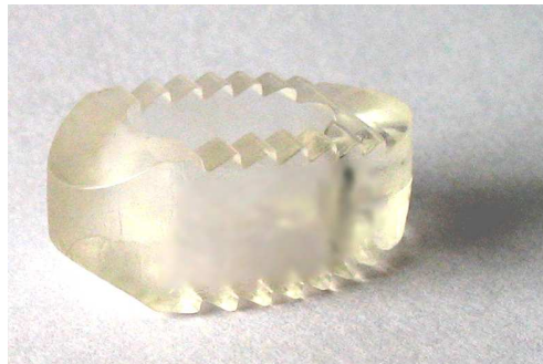
Figura 46- implante degradado por 6 meses, mostrando perda do aspecto transparente inicial.
