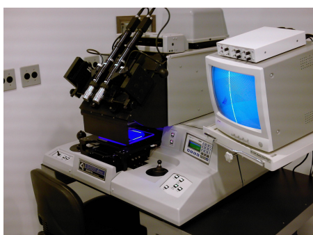
Figura 5.4 - Alinhadora de fotomáscaras, da empresa Quintel Corporation, modelo Q4000-6TL 6".
