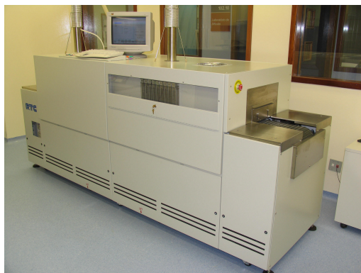
Figura 5.25 - Forno de infravermelho para recozimento da malha metálica.
