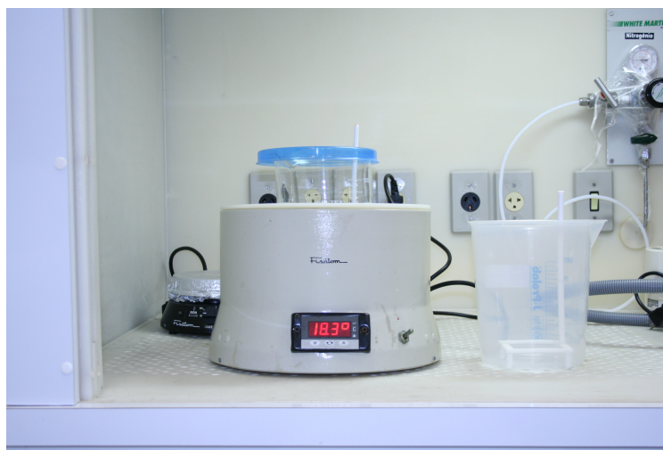
Figura 5.11 – Dispositivo experimental usado nas deposições de níquel, cobre e prata.
