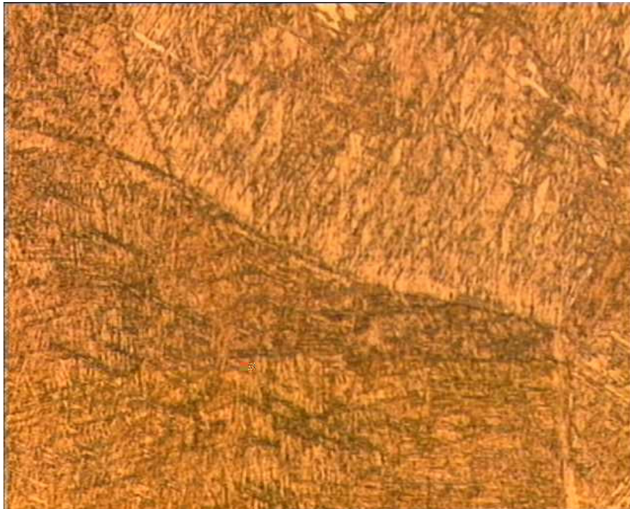
Figura 8: Fotografia de uma amostra de implante da liga Ti-6Al-4V. Ampliação 1000 x em MO.
