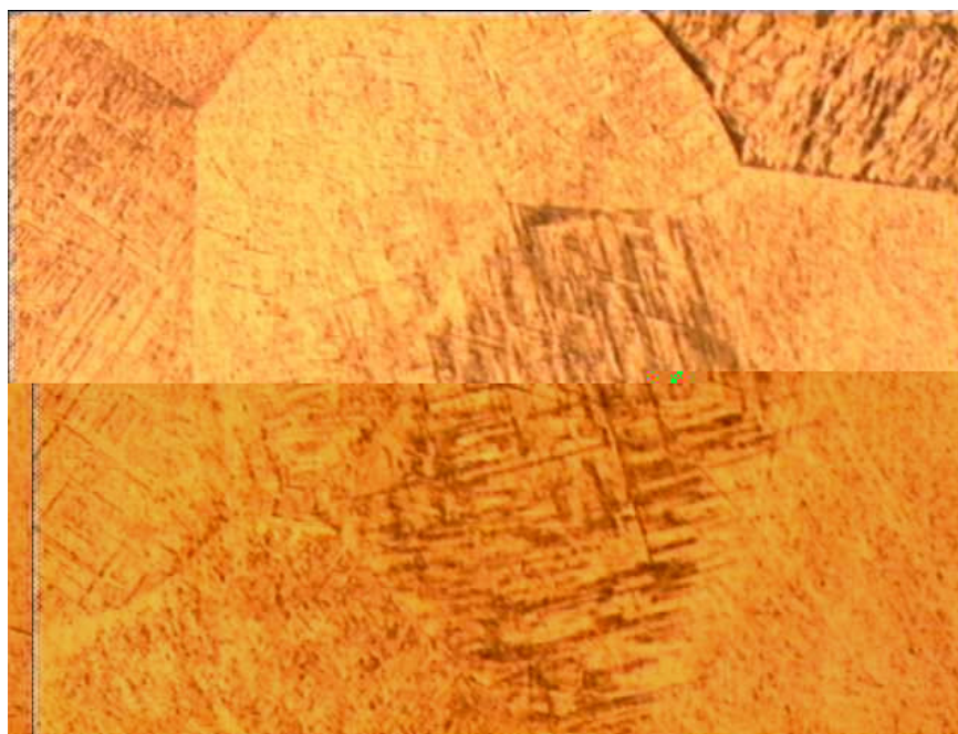
Figura 38: Fotografia da liga de Ti-6Al-4V. Ampliação 1000 x, em MO.
