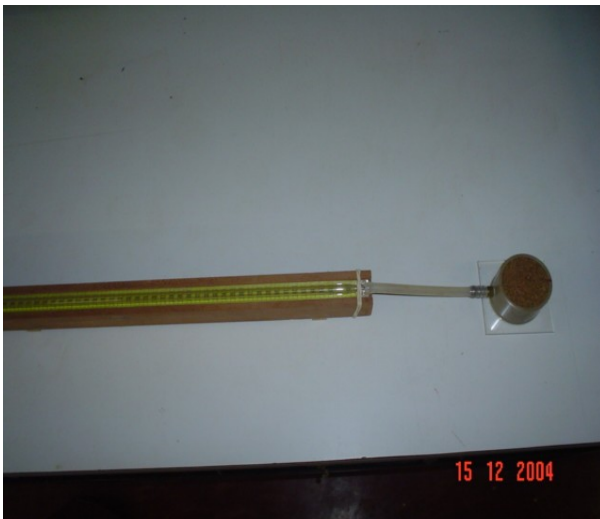
Figura 10. Tubo graduado com a pedra porosa para o teste de absorção
