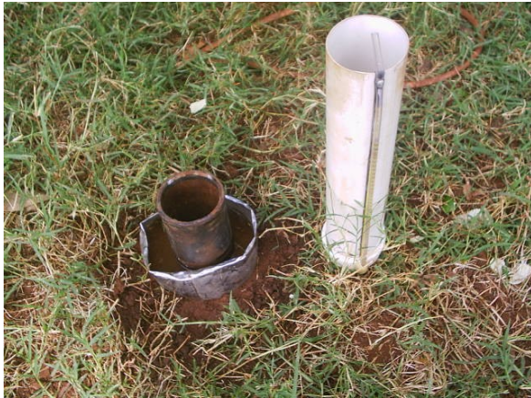
Figura 9. Infiltrômetro, instalado no ponto 3 no setor leste da bacia
