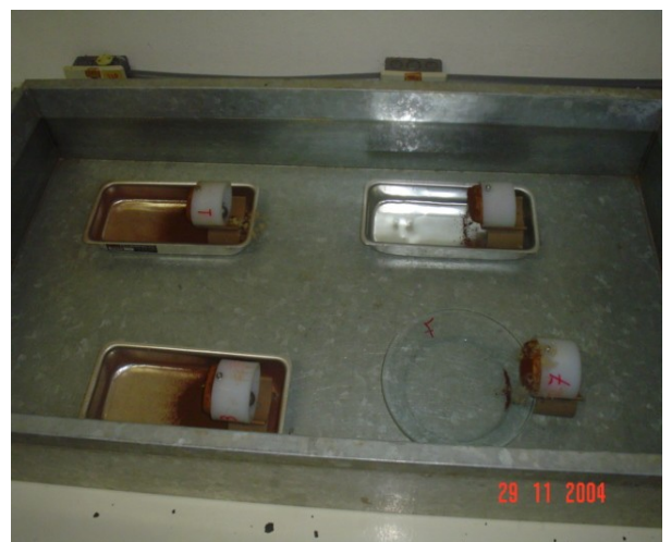
Figura 12. Tanque de água com as mostras para o teste de perda de solo por imersão
