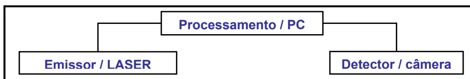
Figura 13 – Diagrama de blocos básicos de um sistema de triangulação laser.
