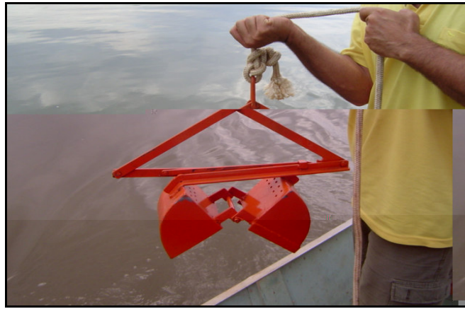
Figura 11 - Amostrador de fundo tipo van-veen
