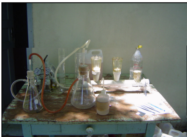
Figura 10 - Processo de filtração da carga suspensa hidrotransportada
