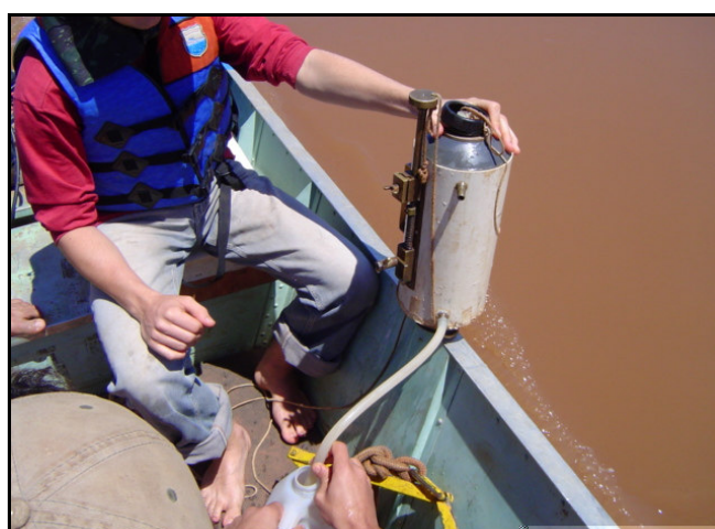
Figura 9 - Amostrador de carga suspensa (Garrafa de Van dorn)
