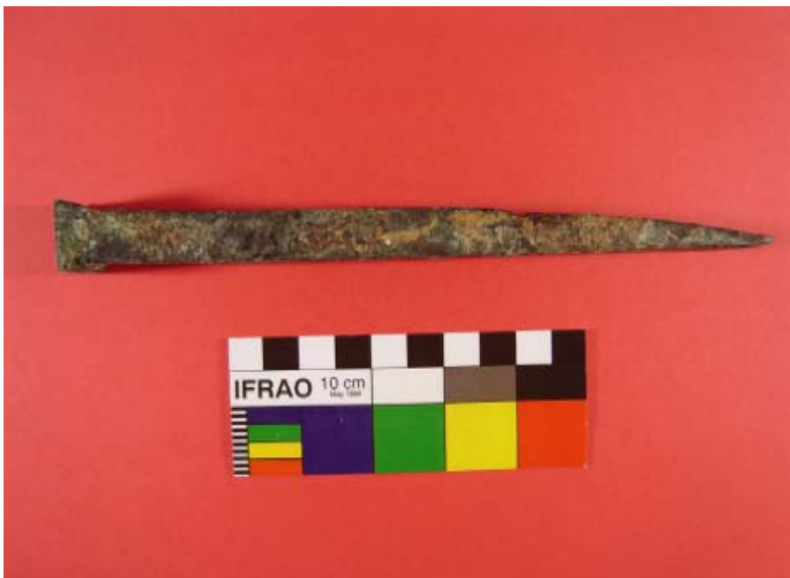
Foto 35: Cavilha com cabeça e corpo de formato quadrangular, técnica construtiva iniciada a partir do primeiro quartel do século XIX. Relação cobre/estanho, 9:1.
