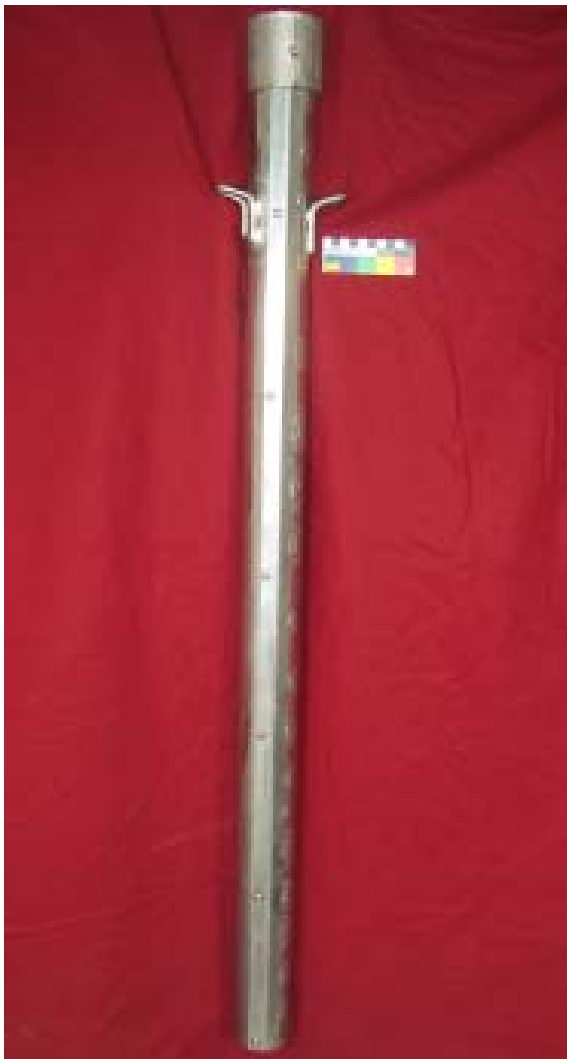
Foto12: Testemunhador de camada estratigráfica, adaptado pelo autor.
