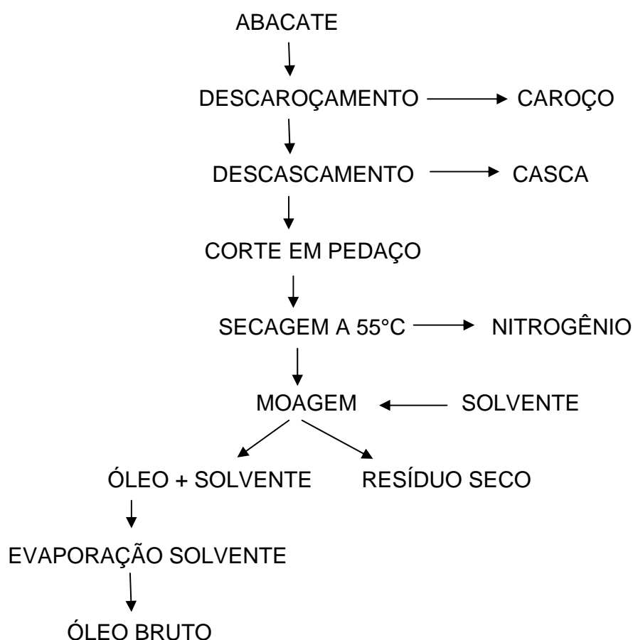
Figura 2 - Fluxograma básico do processo de extração do óleo de abacate por solvente
