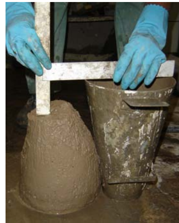
Figura 11: aspecto do concreto produzido com agregado reciclado Figura 12: verificação do abatimento do concreto
