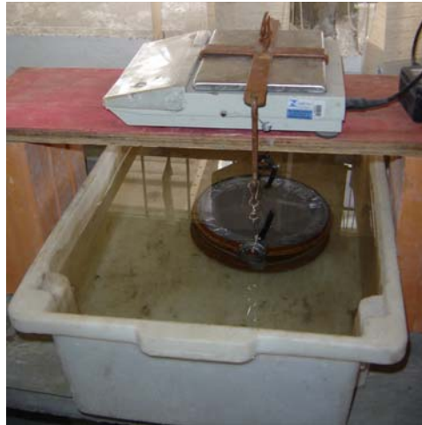
Figura 5: execução do ensaio de absorção dos agregados reciclados
