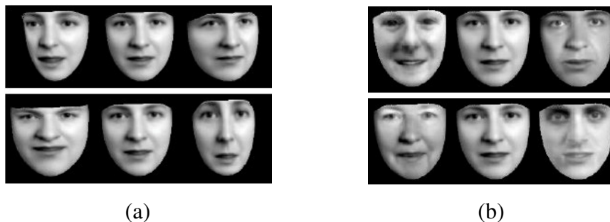
Figura 2.12 - Exemplos dos modos de variação em forma (a) e em textura (b) das imagens de faces variando-se o parâmetro \gamma dentro dos limites de \pm 3sd ( standard deviation ). Adaptado de (COOTES; TAYLOR, 2004) página 32.
