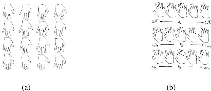
Figura 2.9 - A figura (a) representa o conjunto de treinamento, cujas formas foram obtidas a partir de 72 marcos referenciais. Em (b) temos a reconstrução das formas utilizando-se a equação (2.19) e variando-se os valores do vetor b_f . Adaptado de (COOTES et al., 1994), página. 47.
