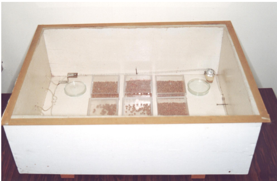
Figura 2: Estufa de madeira (90x50x30cm) com tampa de vidro, onde foram mantidas as criações e os experimentos com Z. subfasciatus .
