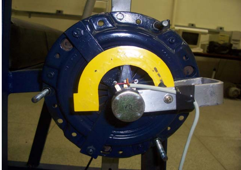
Figura 18 – Mecanismo de resistência bidirecional – potenciômetro montado no eixo de rotação.
