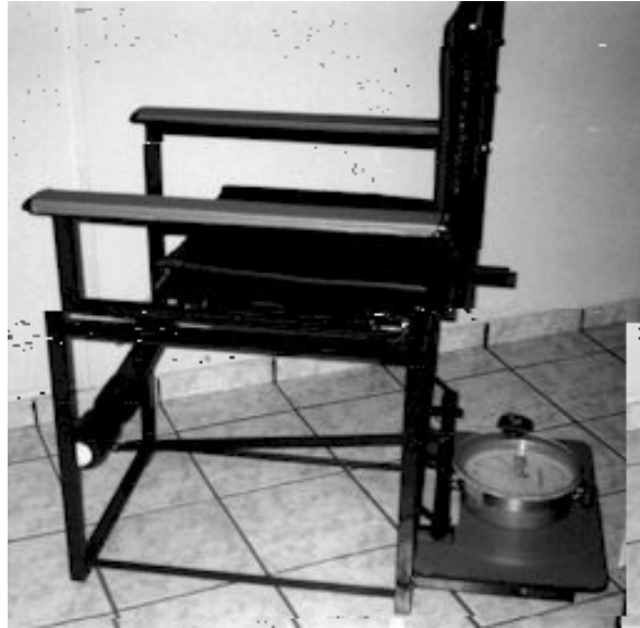
Figura 7 – Dinamômetro analógico. Adaptada de Canto et al (2004).
