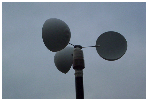
Figura 19 Anemômetro de copos experimental.
