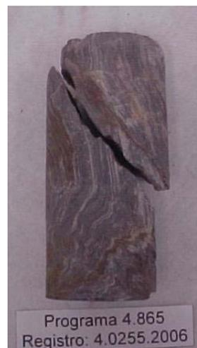
\* A curva Tensão X Deformação não permite sua utilização para a obtenção das constantes elásticas, devido à heterogeneidade do corpo de prova e ou a localização da superfície de ruptura.
