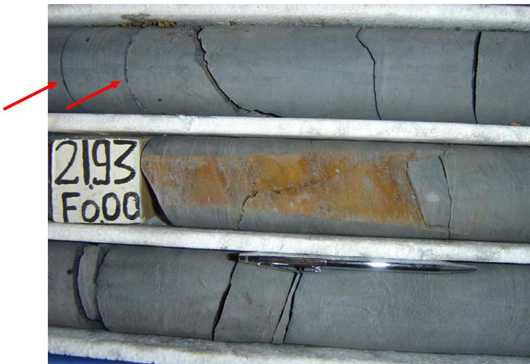
**Figura 5.1** – Observa-se a foliação finíssima (submilimétrica) e algumas das fraturas mostradas na fotografia que podem ter sido induzidas mecanicamente; especialmente as indicadas com setas.
