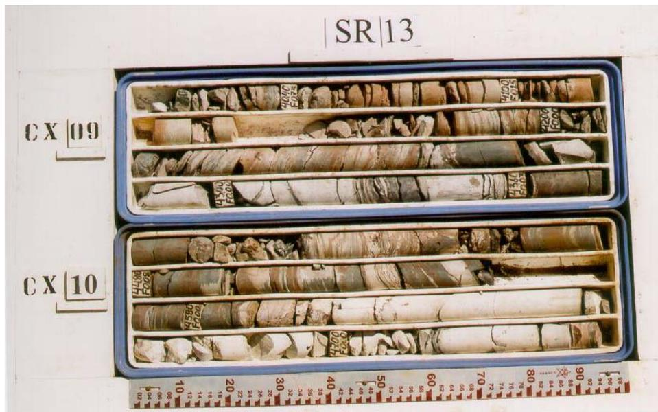
**Figura 4.5** – Detalhe dos testemunhos da SR-13 (39,3 a 47,6m)
