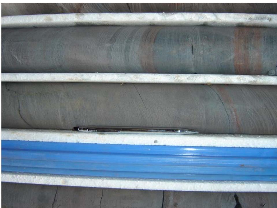
**Figura 4.9** – Trecho em filito grafitoso, praticamente contínuo, com poucas fraturas ao longo da foliação.
