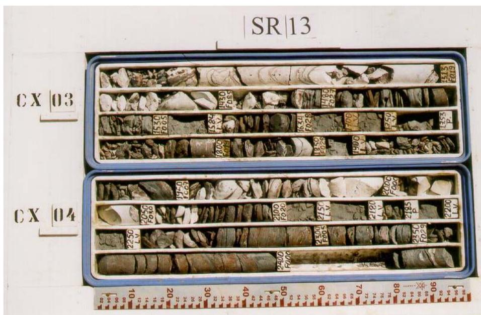
**Figura 4.2** – Detalhe dos testemunhos da SR-13 (12,0 a 24,4)
