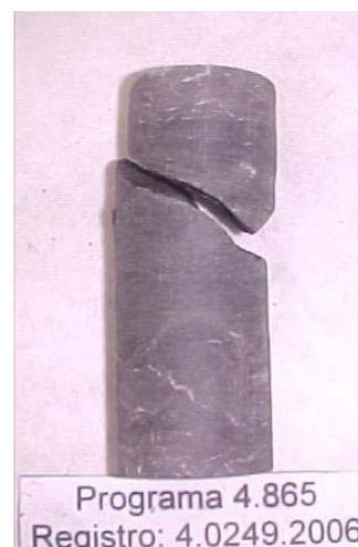
\* A curva Tensão X Deformação não permite sua utilização para a obtenção das constantes elásticas, devido à heterogeneidade do corpo de prova e ou a localização da superfície de ruptura.
