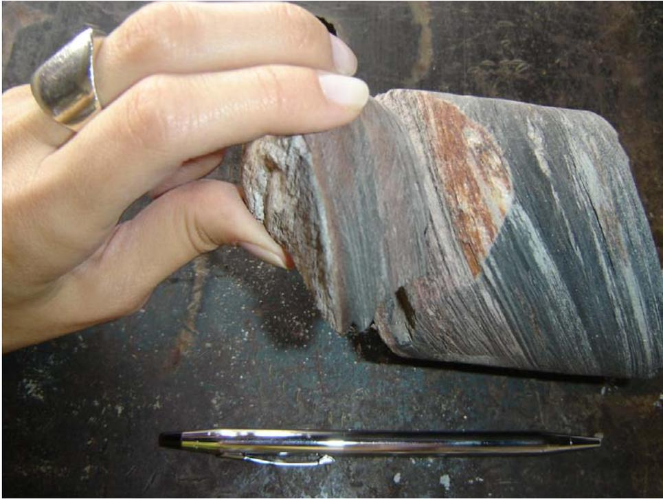
**Figura 3.9** – Fratura rugosa e oxidada, discordante da foliação.
