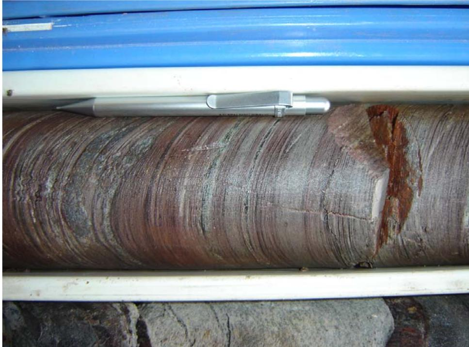
**Figura 3.5** – Alternância de filitos, filitos grafitosos e quartzitos em trecho da sondagem SM-301.
