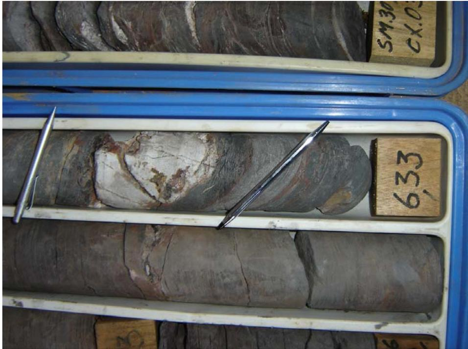
**Figura 3.7** – Variação dos ângulos de mergulho da foliação em trecho de 30cm de sondagem.
