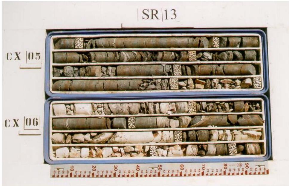
Figura 4.3 – Detalhe dos testemunhos da SR-13 (24,4 a 32,0m)
