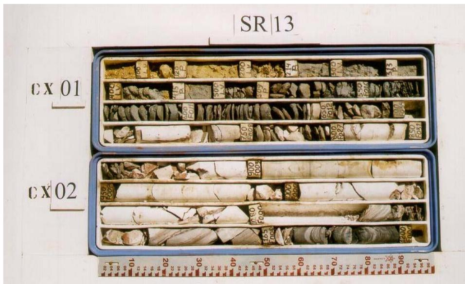
**Figura 4.1** – Detalhe dos testemunhos da SR-13 (0,0 a 12,0m)
