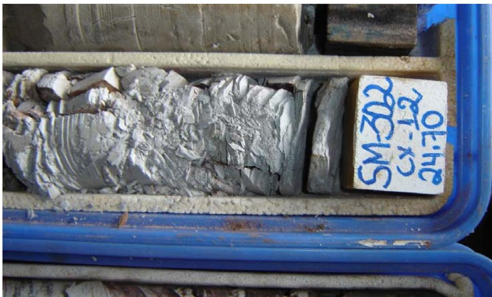
**Figura 3.11** – Alteração do filito, com RQD entre 90 e 100 que, depois de saturado, esfarela-se ao simples toque.
