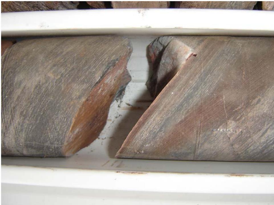
**Figura 4.8** – Fratura do testemunho ao longo da foliação, no contato entre litologias.
