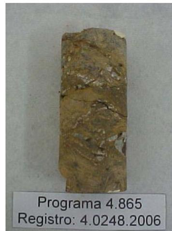
\* A curva Tensão X Deformação não permite sua utilização para a obtenção das constantes elásticas, devido à heterogeneidade do corpo de prova e ou a localização da superfície de ruptura.
