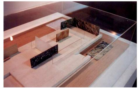
Fig. 74 – Reprodução de maquete de estudos com base de argila. Os planos verticais podem ser removidos e relocados em diversas posições.
