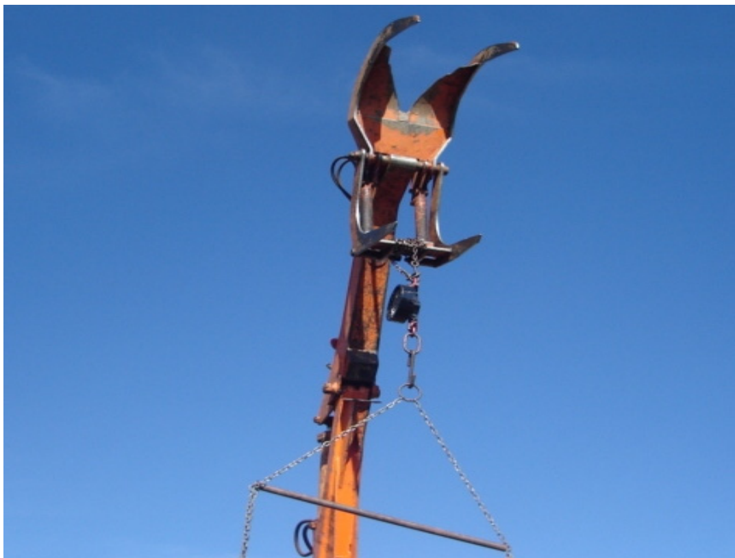
Figura 4. Dinamômetro acoplado a garra da carregadora.
