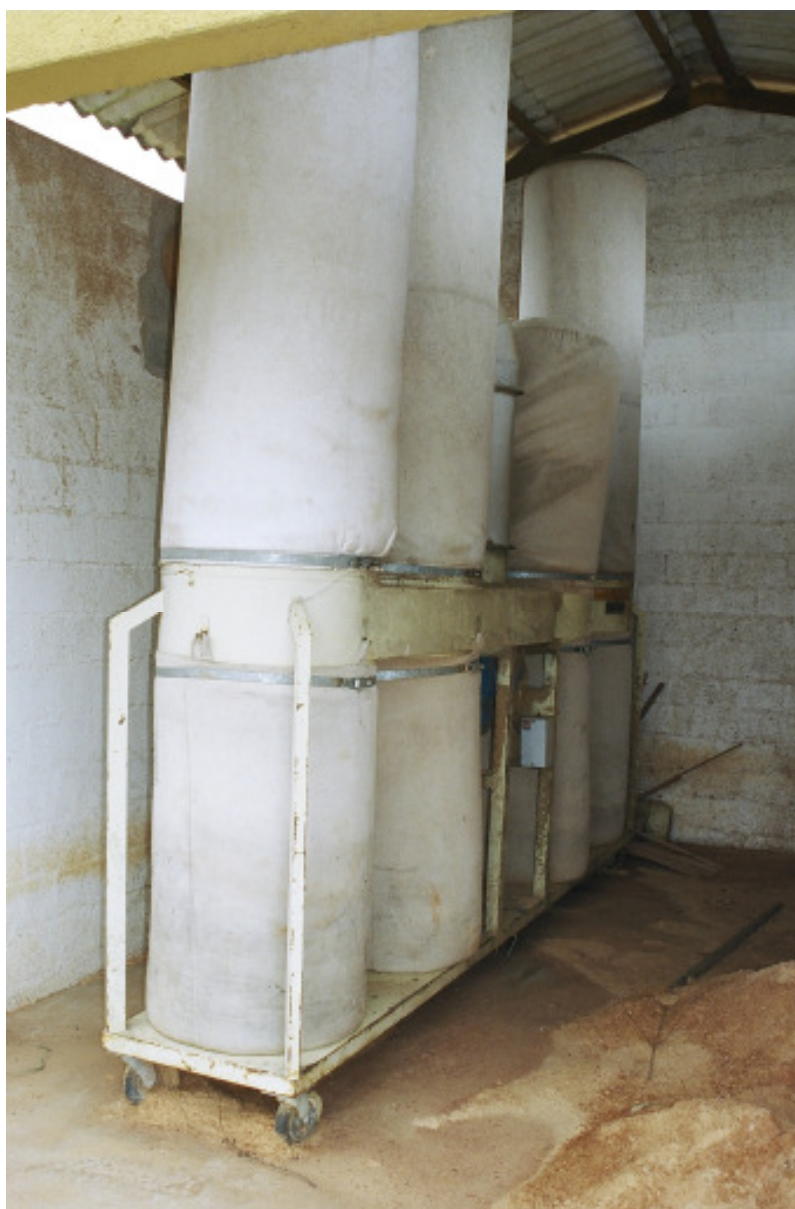
Figura 8.1 – Coletor de pó com motor elétrico de 25cv.
