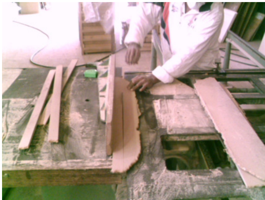
Figura 8.15 – Corte no sentido do comprimento com largura de 40mm.
