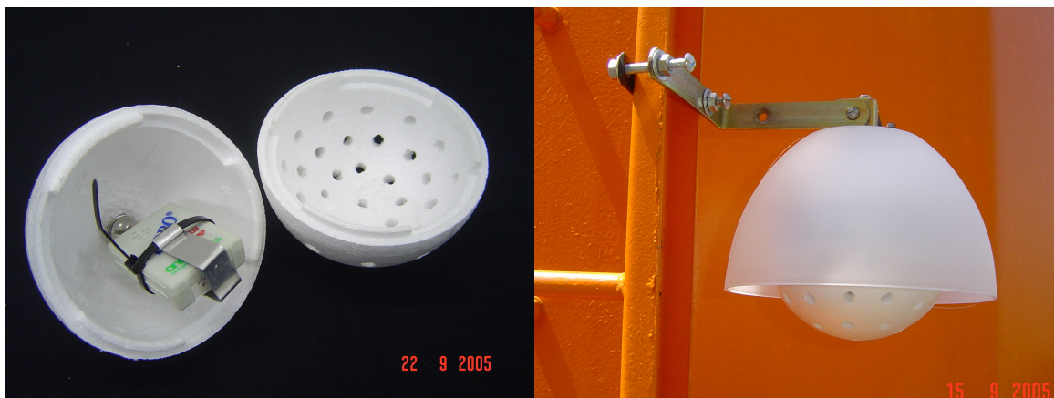
Figura 5.4 – Fotografias dos elementos componentes da proteção do equipamento e da forma de fixação do mesmo na escada.
