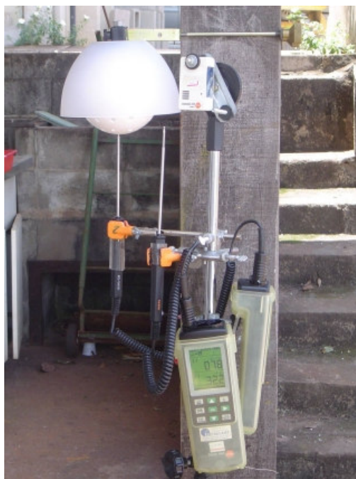
Figura 5.7 – Conjunto montado para verificar ventilação do sensor
