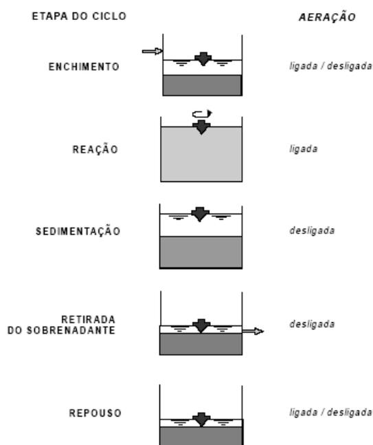
Figura 2. Ciclos do processo de operação intermitente. (VON SPERLING, 2001).
