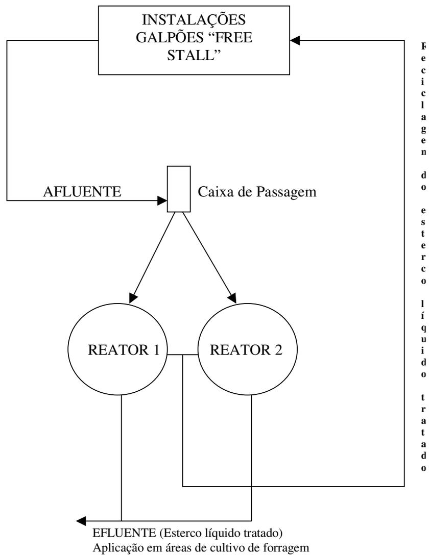
Figura 7. Diagrama do sistema de tratamento biológico de esterco líquido com reciclagem do efluente.
