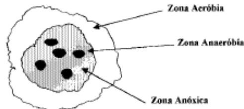
Figura 3. Floco de lodo ativado (BITTON, 1994).
