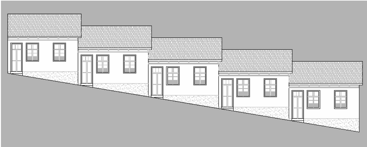
Figura 4.3.3.3: Fachadas das casas-tipo da Companhia Industrial e Construtora Pantaleone Arcuri. Fonte: Levantamento da autora.
