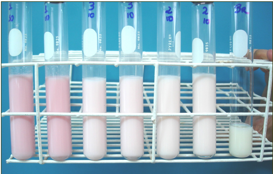
Figura 10: Amostras de leite pasteurizado, submetidas à prova rápida de redução em tubos, apresentando desenvolvimento da coloração a partir da redução do TTC.
