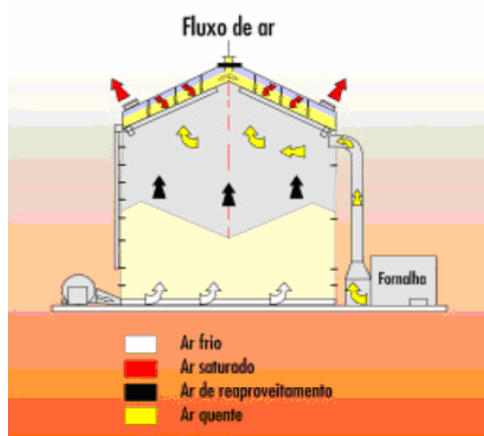
Figura 7: Esquema de um silo secador (Fonte: Kepler Weber, 2005)
