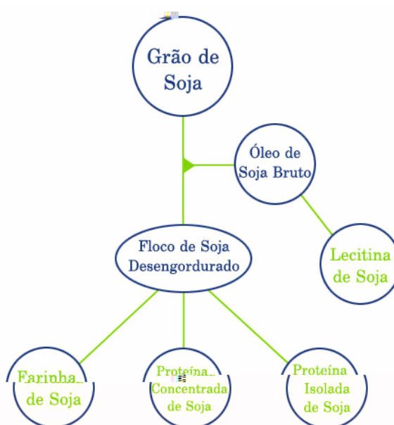
Figura 3: Esquema do processamento dos grãos de soja (Fonte: The Solae Company, 2004)
