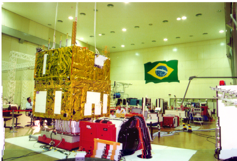
Figura 1.1: Vista do LIT-INPE: CBERS-2 durante teste de vibração Fonte: Instituto Nacional de Pesquisas Espaciais (2006d).
