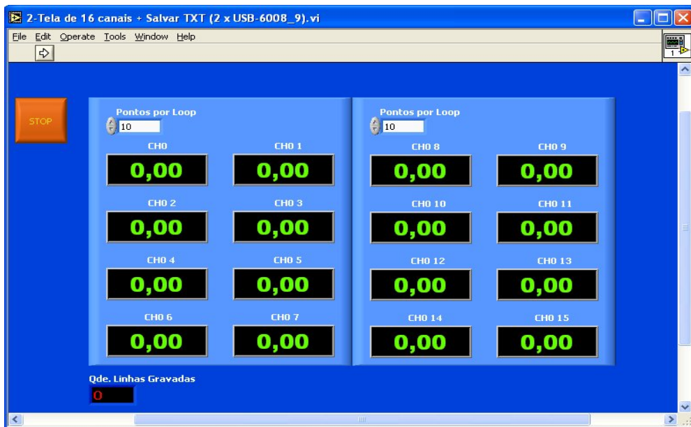
Figura 7.15 – Tela do programa desenvolvido para realizar a leitura do valor de saída de cada sensor
