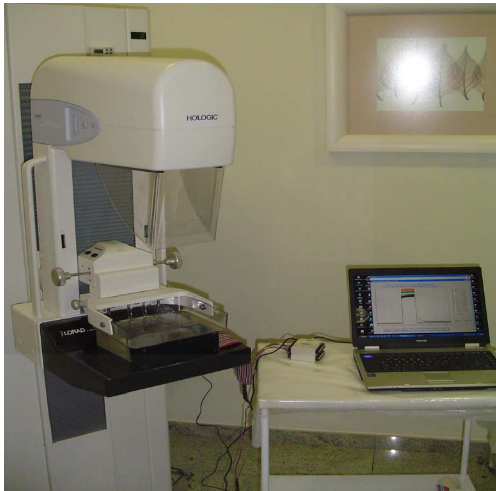
Figura 8.1 – Sistema desenvolvido em testes junto a um mamógrafo Lorad Selenia: Simulador sobre a mesa de posicionamento da mama acoplado por cabos ao notebook
