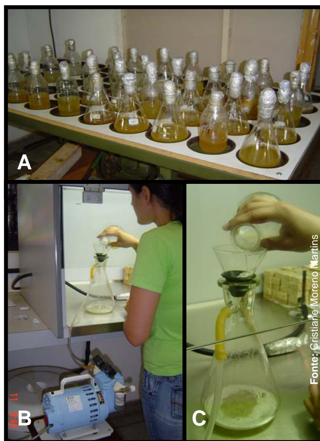
Figura 8.2. Isolados de bactérias e actinomicetes antagonistas em meio BD (batata e dextrose) e Jensen líquido (A). Filtragem da solução bacteriana e de actinomicetes, com o auxílio de Kitassato e membrana de celulose (B e C).
