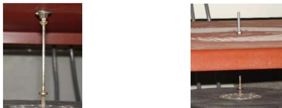
Figura 3.3 – Detalhes da haste utilizada para transmissão da excitação no *set-up* experimental.
