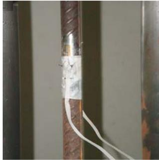
Figura 3.1: Extensômetros na barra de  $\phi = 16$  mm.
