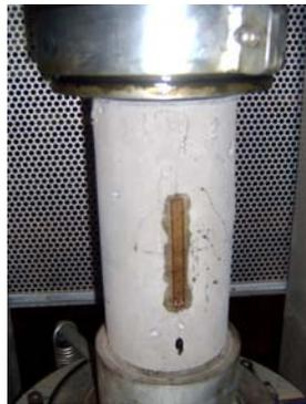
Figura 4.1: Posicionamento dos extensômetros nos corpos-de-prova de concreto para a determinação das deformações longitudinais, colados em geratrizes diametralmente opostas.
