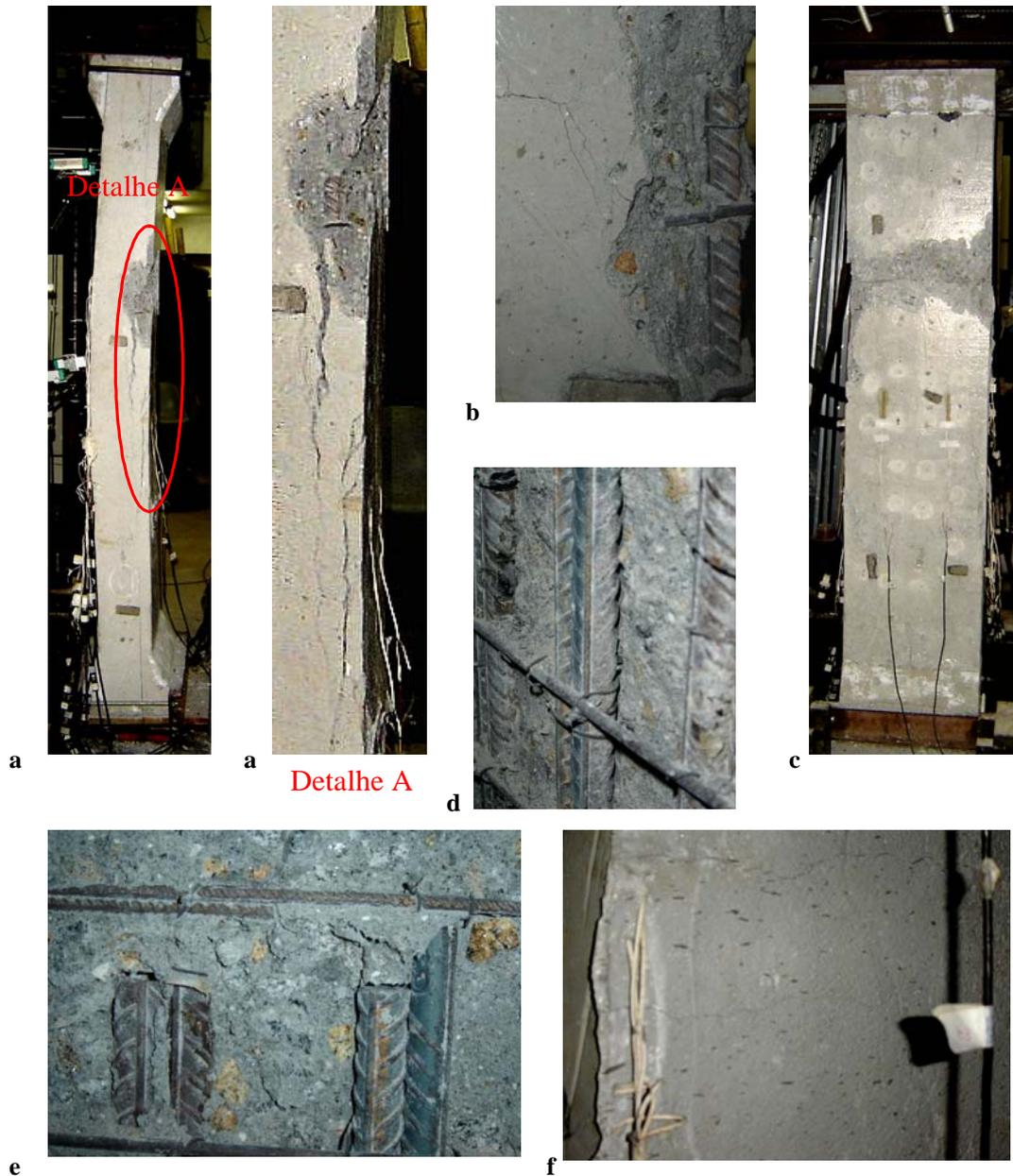
Figura 5.11: Pilar PRS-2 depois da ruptura; a: Vista lateral do pilar e detalhe A; b: Detalhe de uma barra de esquina do pilar; c: Vista frontal; d: Detalhe mostrando a perda de aderência barra-concreto; e: Detalhe da zona da extremidade da emenda; f: Vista frontal da zona tracionada fissurada.
