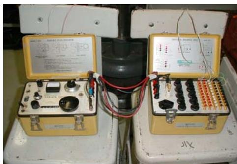
Figura 3.3: Aparelho usado para medir as deformações.
