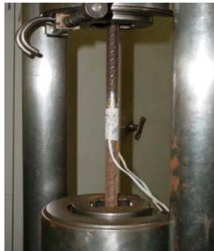
Figura 3.2: Ensaio da barra na máquina Amsler.
