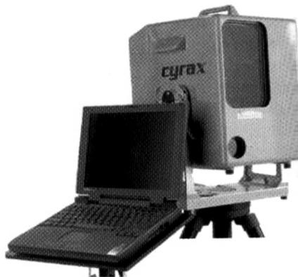
Figura 52. Scanner laser 3D, para levantamento de lugares de grande dimensão.
