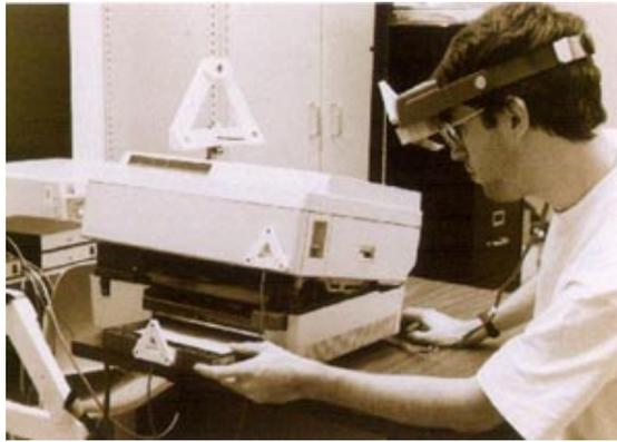
Figura 31. Traçadores triangulares anexados à várias partes da impressora.
