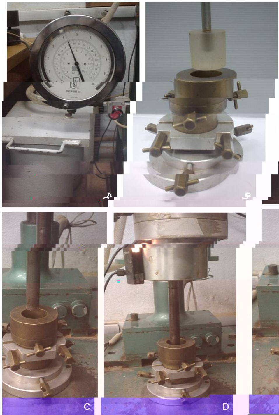
Figura 4.5-Rotina do ensaio de pisoteamento.
