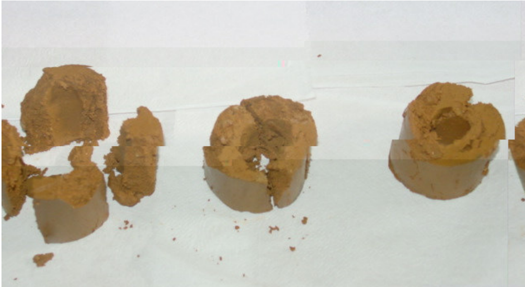
Figura 5.19-Corpo de prova deformado devido às elevadas pressões de pisoteamento.
