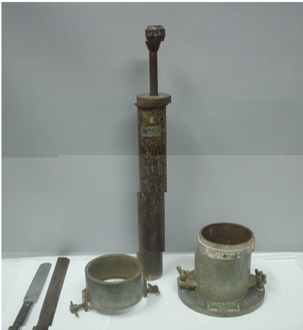
Figura 4.1-Instrumentos do ensaio Proctor Normal.
