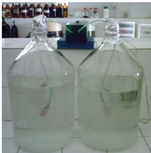
**Figura 4.10** – Aeração da água em garrafões (AESA)
