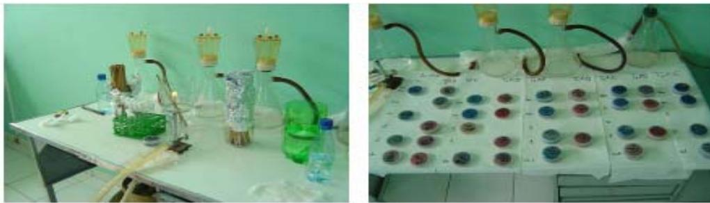
**Figura 4.4** – Sistema de filtração por membrana montado no laboratório de campo do sítio Riacho da Serra, São José do Sabugi/PB e colônias típicas de coliformes termotolerantes, no meio Agar m FC.
