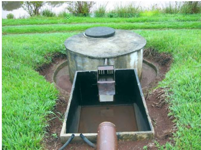
**Figura 5.** Tanques de decantação e de armazenamento para monitoramento de perdas por erosão de terra e de água. Instituto Agronômico, Campinas, SP.
