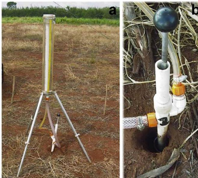
**Figura 7.** a: Permeâmetro modelo IAC para determinação da infiltração e condutividade hidráulica; b: detalhe tubo acrílico para determinação da carga hidráulica.
