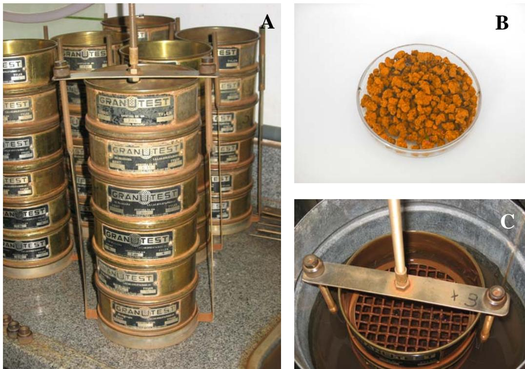
**Figura 8.** Determinação da estabilidade de agregados por via úmida. **A:** Conjunto de seis peneiras utilizadas no peneiramento; **B:** Agregados selecionados de tamanho entre 9,52 mm e 4,00 mm.; **C:** Detalhe da peneira superior com diâmetro de 7,93 mm.
