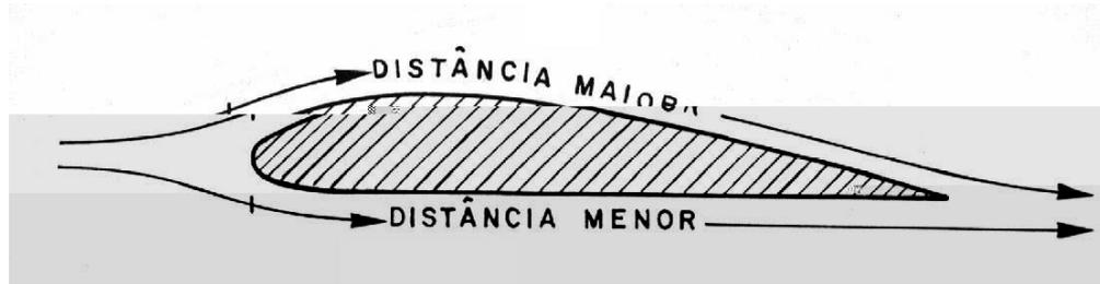
Figura 2.11 – Fluxo em torno do aerofólio – Fonte: termo.furg.br/JAA/index.php
