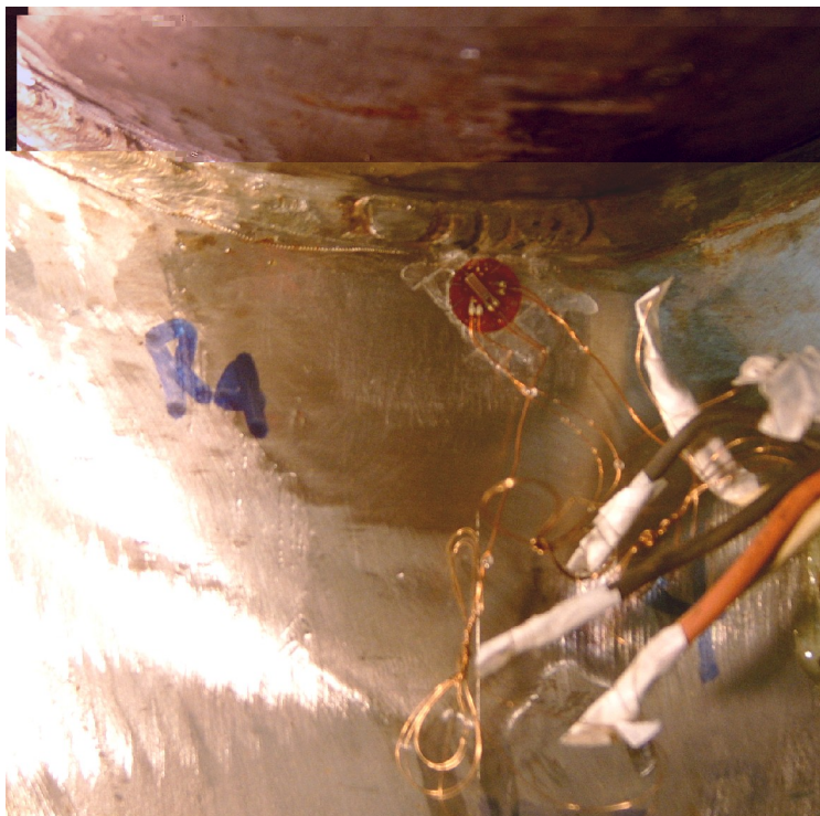
Fig. 6.25: detalhe da roseta R4 (vide Fig. 6.6).
