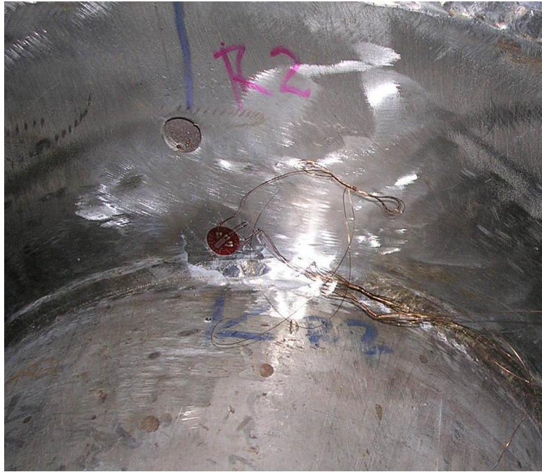
Fig. 6.8: vaso-cobaia no LABEST (extensometria na origem do colarinho maior).
