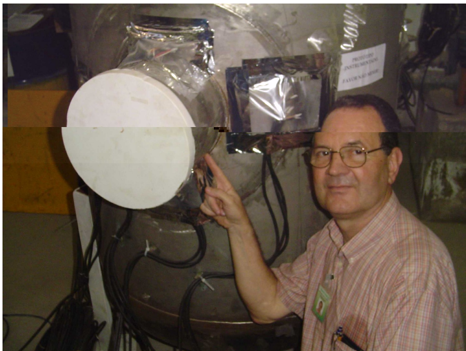
Fig. 6.7: vaso-cobaia no LABEST (verificando o bocal maior).
