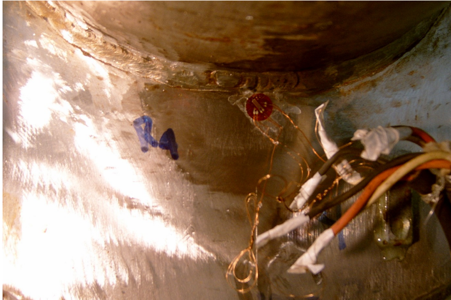
Fig. 6.10: vaso-cobaia no LABEST (detalhe da roseta R4).
