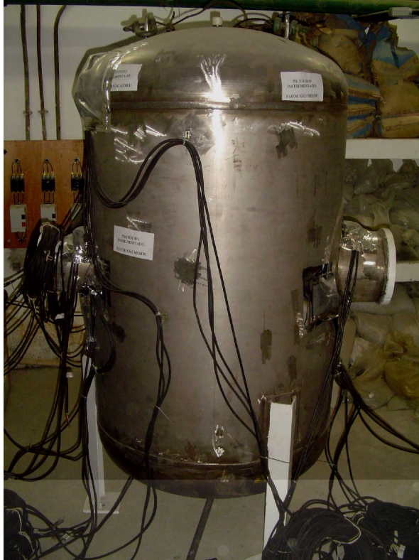
Fig. 6.6: vaso-cobaia no LABEST (finalizando a instalação dos extensômetros).
