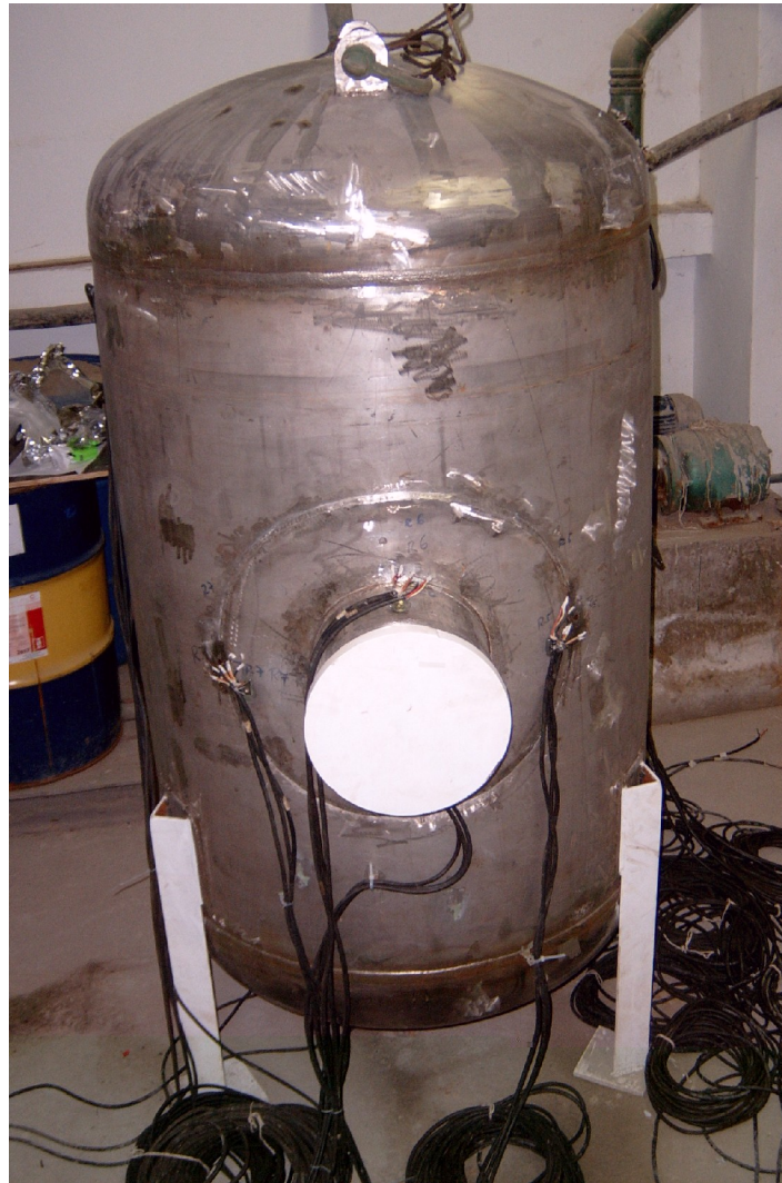
Fig. 6.16: vista geral do vaso-cobaia, instrumentado com EER's.
