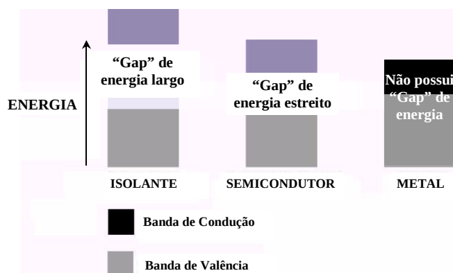
Figura 2.7: Estruturas de bandas de materiais isolante, semicondutor e metálico [1].
