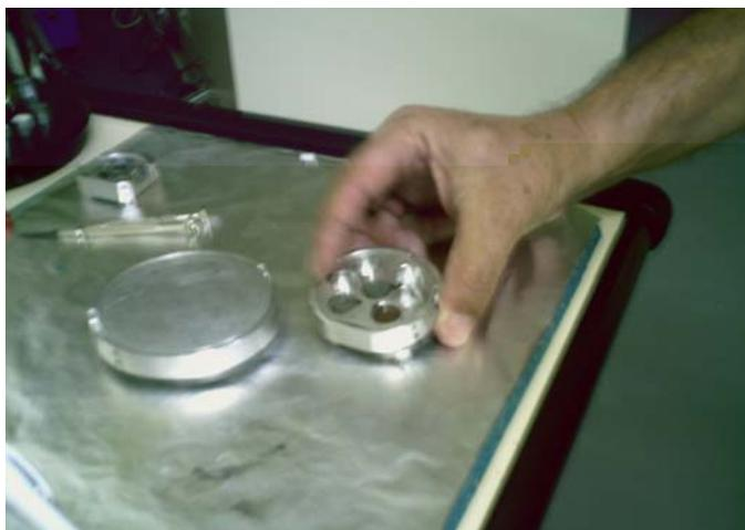
**Figura 3.7:** Suporte da amostra analisada do equipamento de MEV
