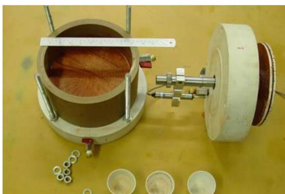
**Figura 3.12:** Foto da célula de adensamento de lamas desenvolvida
