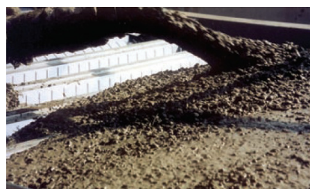
Figura 2.24 – Aspecto do concreto reforçado com fibras (adaptado de Stadlober, 2005).
