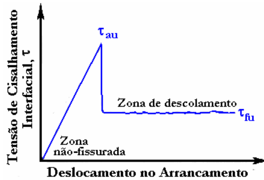
Figura 2.7 – Representação das tensões tangenciais (de cisalhamento) na interface fibra-matriz (adaptado de Bentur e Mindess, 1990).
