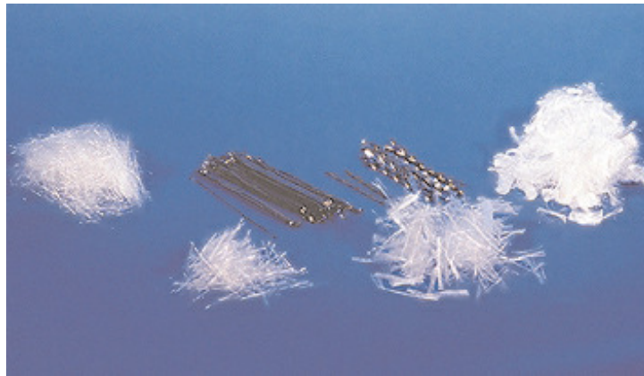
Figura 2.1 – Fibras de Aço, de Vidro, Sintéticas e Naturais, com diferentes comprimentos e formas, que podem ser utilizadas no concreto (adaptado de CTU, 2006).
