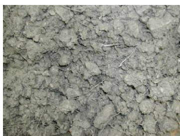
Figura 2.24 – Aspecto do concreto reforçado com fibras (adaptado de Stadlober, 2005).
