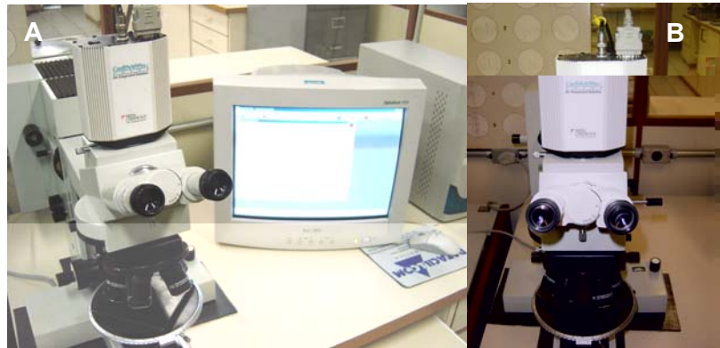
Figura 20 – (A e B) Microscópio óptico metalográfico Jenavert-Carlzeiss/Jena , com lente Planachromat HD 50 x / 0,80 ∞ / 0 – A , da mesma empresa e módulo de aquisição de imagens CoolSNAP-Procf Color / Media Cybernetics acoplado
