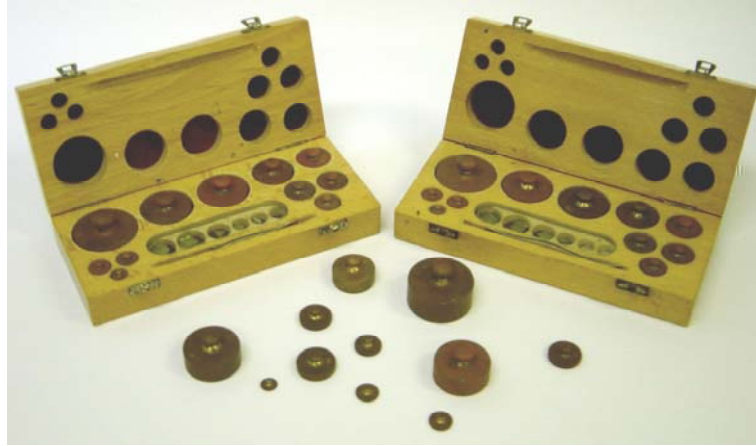
Figura 29 – Massas utilizadas na calibração da plataforma de medição de forças
