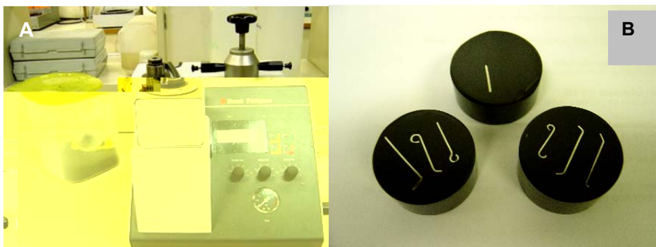
Figura 21 – (A) Prensa metalográfica Predopress-Struers e pó de baquelite; (B) Corpos de prova embutidos em baquelite
