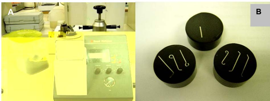
Figura 21 – (A) Prensa metalográfica Predopress-Struers e pó de baquelite;
