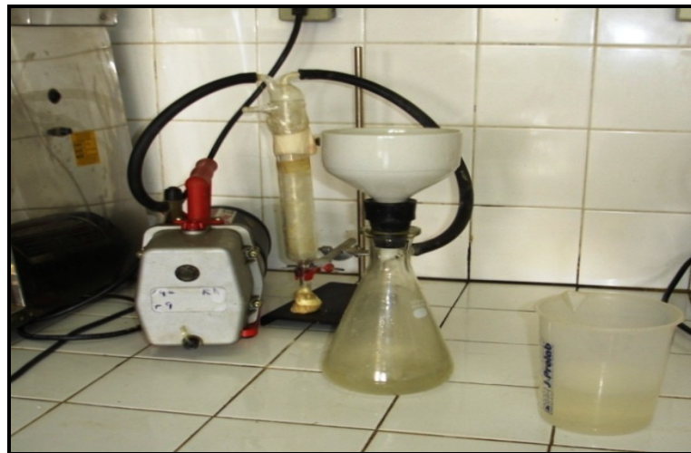
Figura 3.9 - Equipamentos utilizados para obtenção dos extratos lixiviado e solubilizado dos materiais utilizados na pesquisa [Fonte própria]
