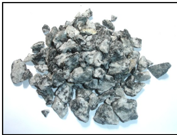
Figura 3.1 – Agregado do tipo granítico – Brita 19 ou 3/4” [Fonte própria]
