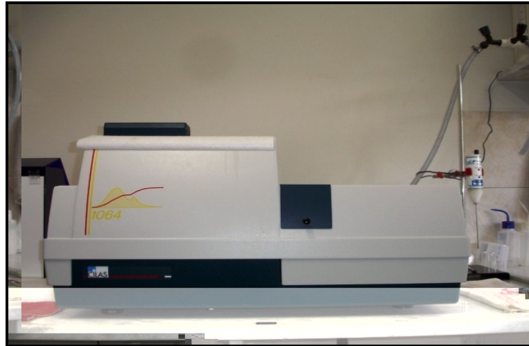
Figura 3.6 - Equipamento utilizado para realização do ensaio de difração a laser [Fonte própria]
