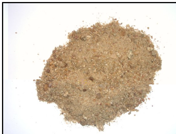
Figura 3.2 - Agregado do tipo quartzosa – Areia de rio [Fonte própria]
