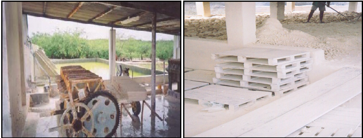
Figura 2.8 - Prensa e armazenamento do Caulim em forma de blocos [Fonte própria]
