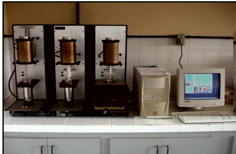
Figura 3.7 - Equipamento utilizado para realização do ensaio de análise termodiferencial e termogravimétrica [Fonte própria]
