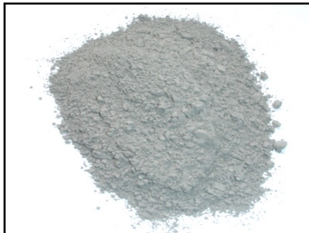
Figura 3.4 – Serragem do granito [Fonte própria]
