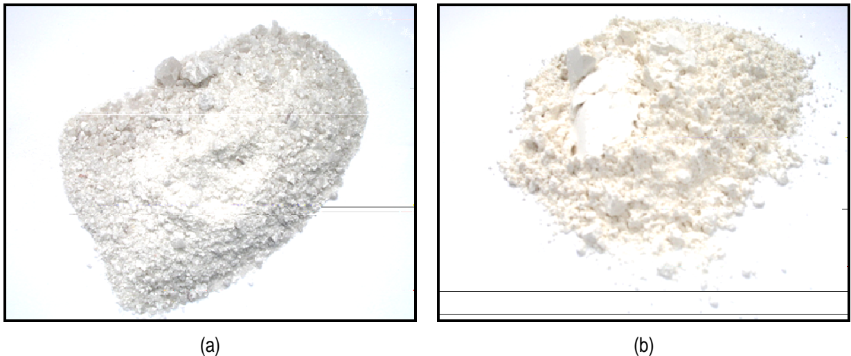
Figura 3.3 – (a) Caulim utilizado como agregado miúdo, (b) Caulim utilizado como filer [Fonte própria]
