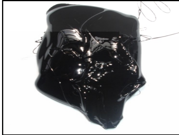
Figura 3.5 – Cimento asfáltico de petróleo utilizado na pesquisa (CAP) [Fonte própria]
