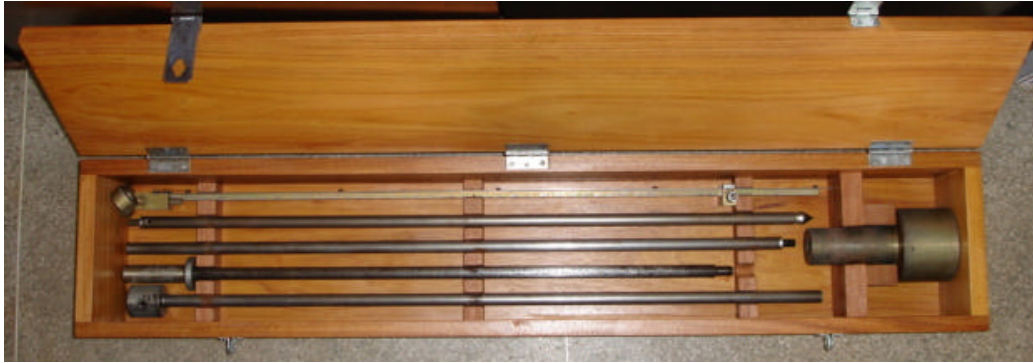
Figura 0.5 - Cone de Penetração Dinâmica - CPD, com as primeiras modificações
