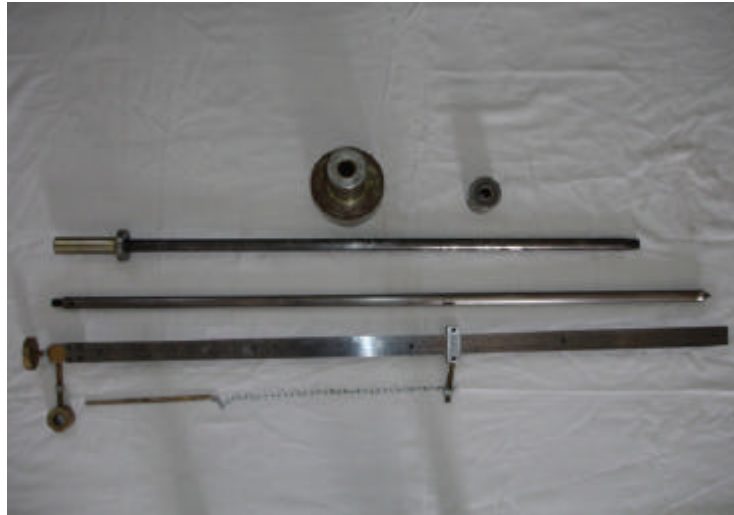
Figura 0.2 - Cone de Penetração Dinâmica, equipamento original desmontado
