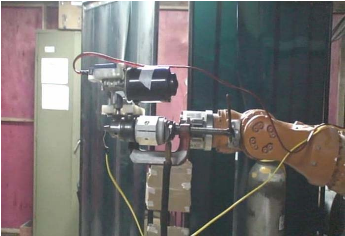
FIG 4.3 - Posição inicial do Manipulador – Mandril fechado.
