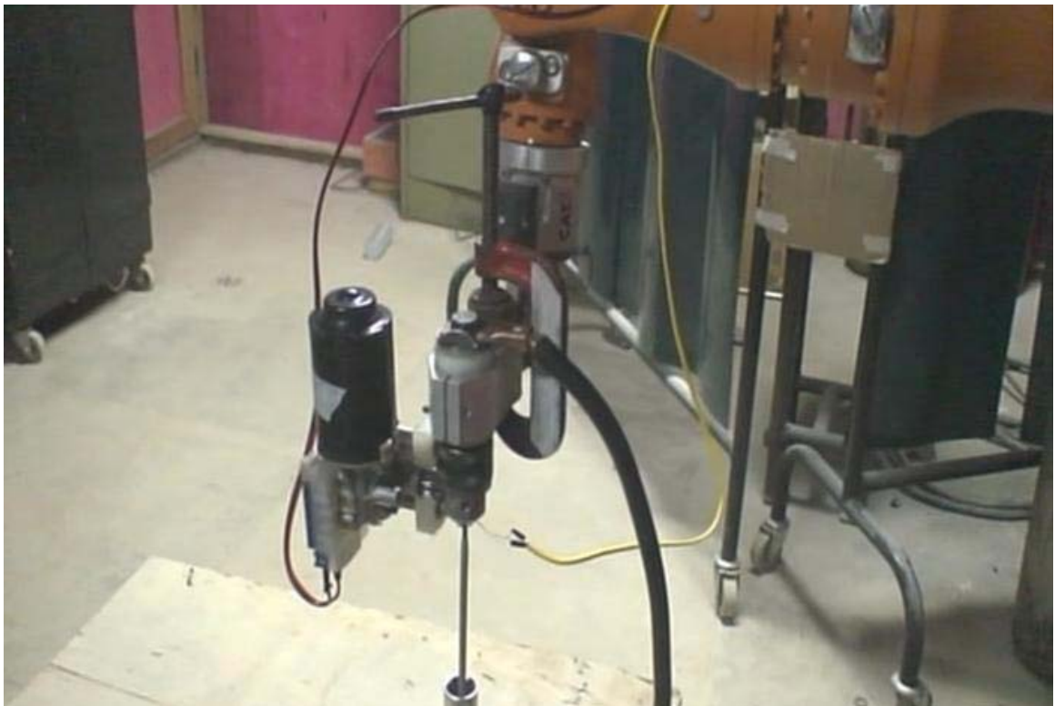
FIG 4.5 - Posição intermediária do Manipulador – Mandril fechado e segurando o eletrodo.
