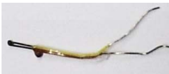
FIG. 3.5 - Termopar com juntas soldadas.
