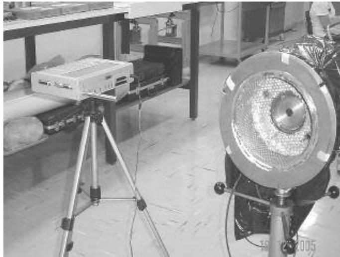
FIGURA 4.11 – Posição do microfone durante os testes.
