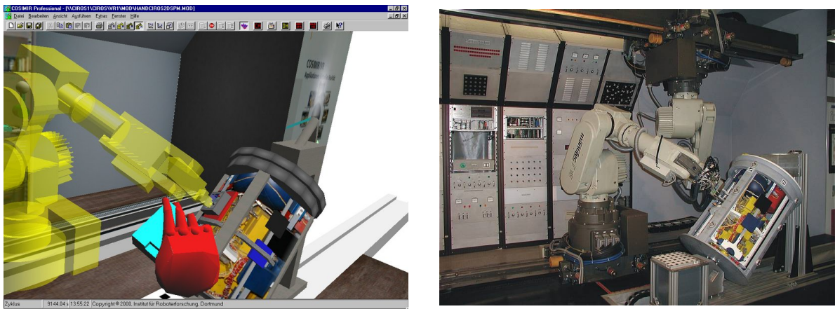
Figura 91. Simulação no COSIMIR vs. realidade.
