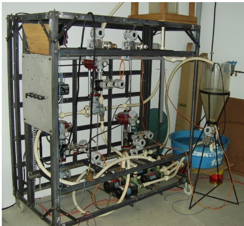
Figura 45. Foto da construção da atual Planta Didática FF da UFRGS.
