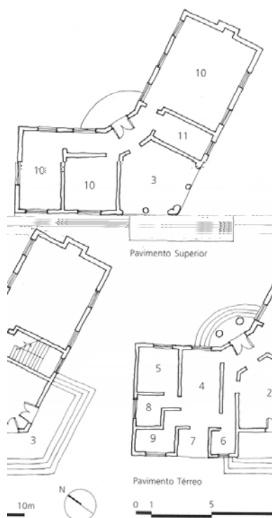
74 - Planta da residência da imagem 73, de Barry Parker. Segundo o desenho: 1- Sala de Visitas, 2- Sala de Jantar, 3- Terraço, 4- Cozinha, 5- Quarto de Empregada, 6- Lavatório, 7- Tanque, 8- Banheiro, 9- Depósito, 10- Dormitório, 11- Banheiro e W.C. Fonte: WOLFF, 2001, p. 172.
