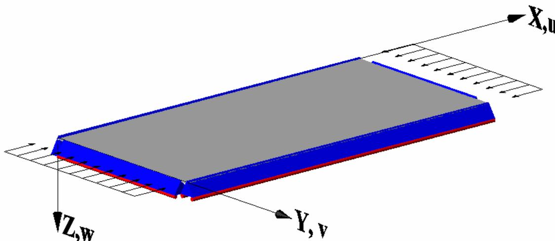
FIGURA 2.3 - Condição de contorno de referência para determinação da tensão crítica de flambagem elástica de placas
