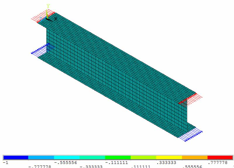
FIGURA 4.6 - Carga de referência para análise elástica do modelo em exemplo
