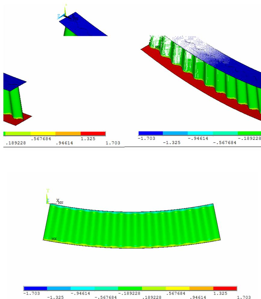
FIGURA 4.21 - Análise elástica estática do modelo em exemplo, carregado com o momento de referência (perspectiva e vista lateral)
