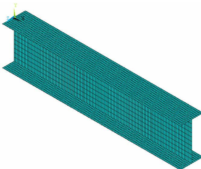
FIGURA 4.5 - Modelo do perfil I de alma plana -  $I 40 \times 0,475 \times 24 \times 0,63$
