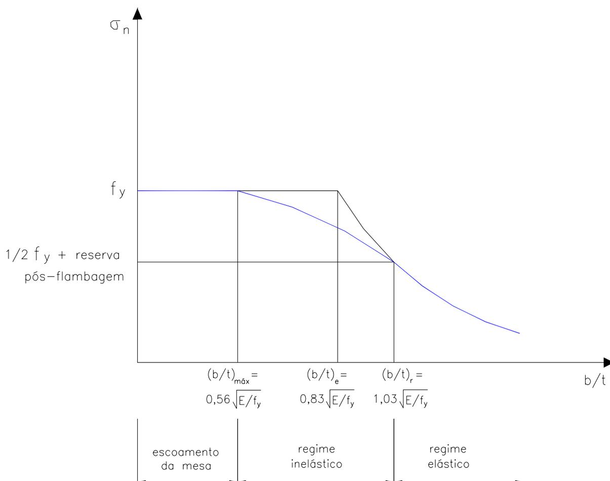
FIGURA 2.8 - Curva  $\sigma_n$  versus  $b/t$  para verificação da FLM de perfis laminados sujeitos a força de compressão, segundo a NBR8800
