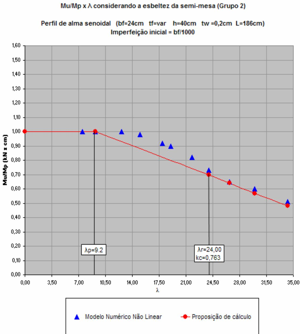
Figura 6.2 - Curva do procedimento proposto e resultados da análise não-linear considerando a semi-largura das mesa na determinação de sua esbeltez (Grupo 2)
