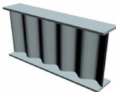
FIGURA 1.4 - Perfil I de alma corrugada senoidal
