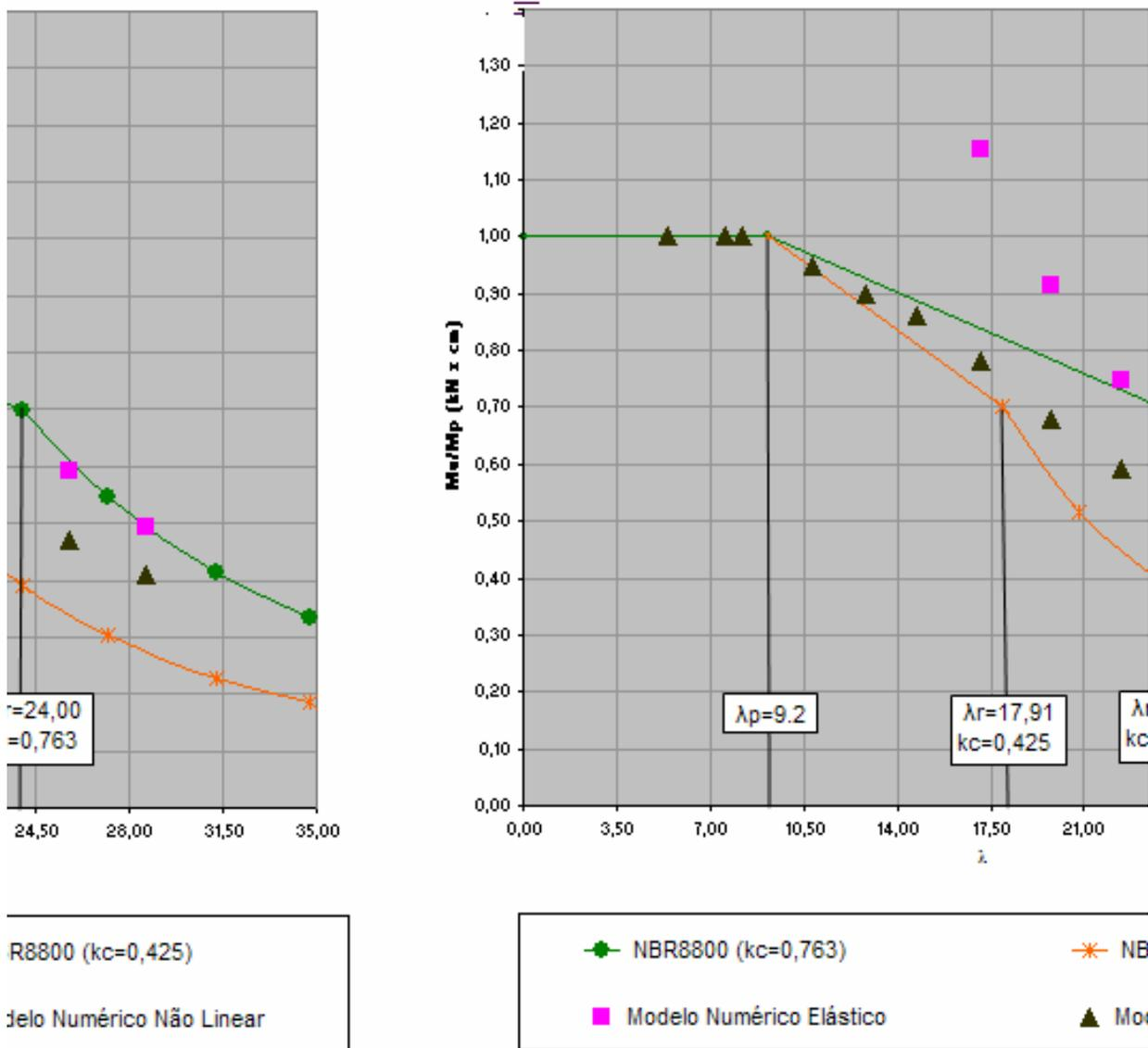
FIGURA 5.6 - Curvas  $M_u/M_p \times \lambda$  da NBR 8800 e resultados numéricos considerando, na determinação da esbelteza da mesa, a largura reduzida proposta pela Zeman (Grupo 1)
