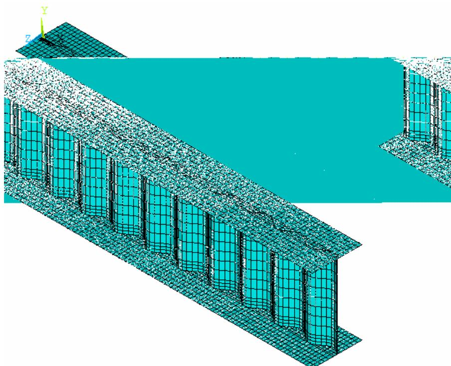
FIGURA 4.18 - Modelo do perfil I de alma senoidal - *I Sen 40 x 0,2 x 24 x 0,63*
