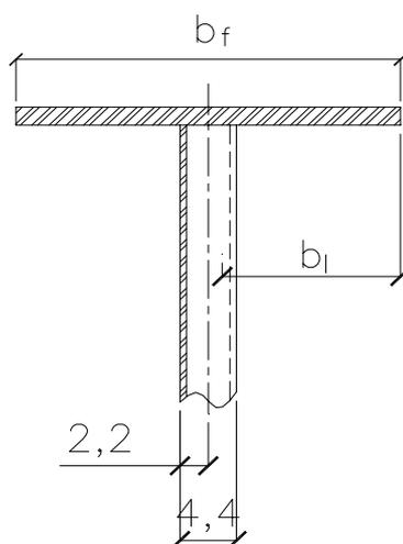
FIGURA 2.12 – Largura livre de mesa  $b_l$  para análise da FLM de perfis de alma senoidal segundo a Zeman (medidas em *cm*)
