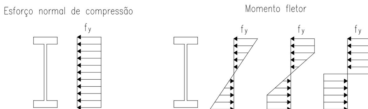
FIGURA 2.9 - Distribuição de tensões para cada tipo de solicitação
