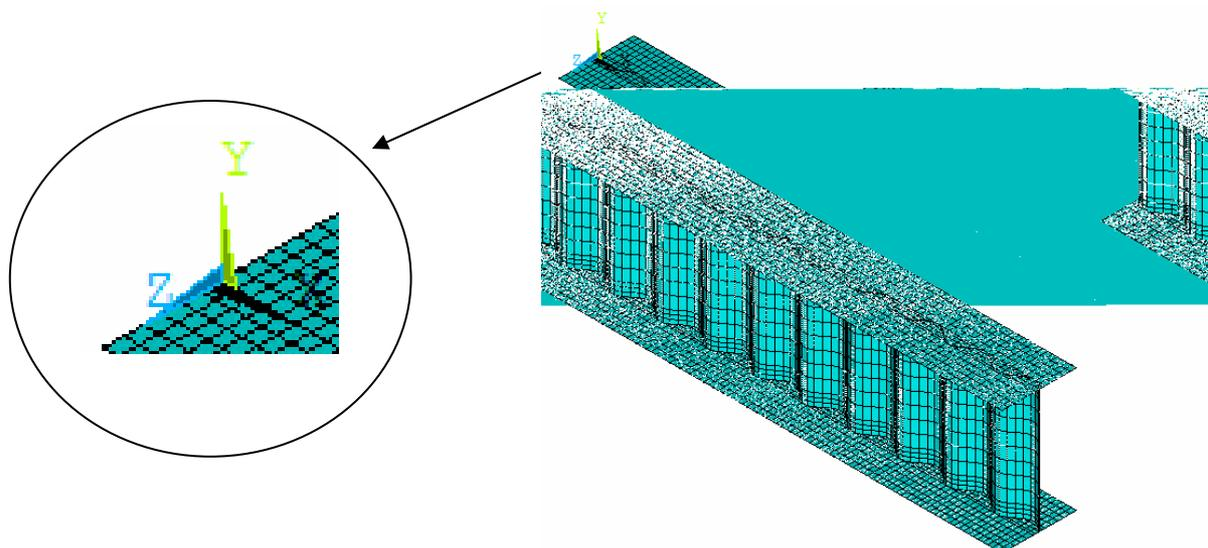
FIGURA 3.4 – Posição do eixo cartesiano na geração dos modelos de perfil I com alma senoidal
