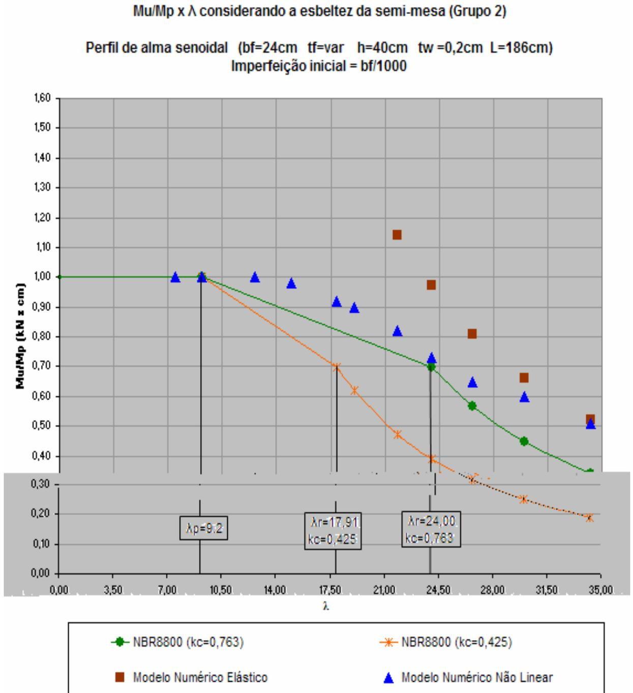
FIGURA 5.7 - Curvas  $M_u/M_p \times \lambda$  da NBR 8800 e resultados numéricos considerando a semi-largura da mesa na determinação da sua esbeltez (Grupo 2)
