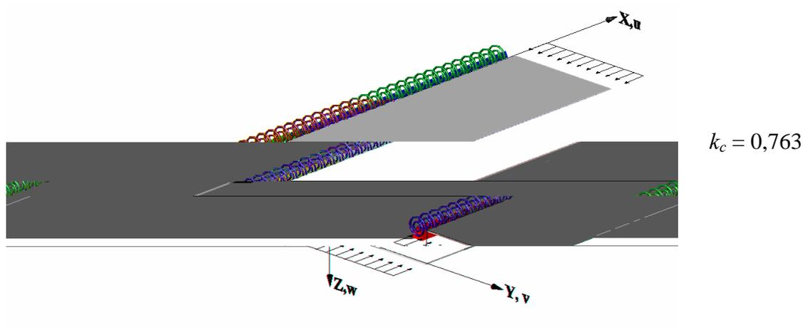
FIGURA 2.7 - Valor de  $k_c$  idealizado para a semi-mesa de perfis I laminados, adotado pela NBR8800
