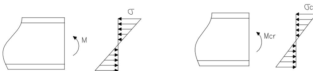
FIGURA 2.10 -  $\sigma$  devido a  $M$  em regime elástico e no instante da flambagem elástica
