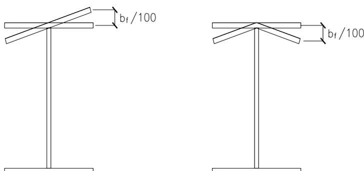
FIGURA 4.13 - Tolerância de fabricação de perfis I soldados segundo a AWS
