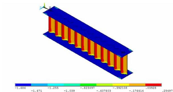
FIGURA 4.28 - Análise elástica estática do modelo em exemplo, carregado com a força de compressão de referência (perspectiva)
