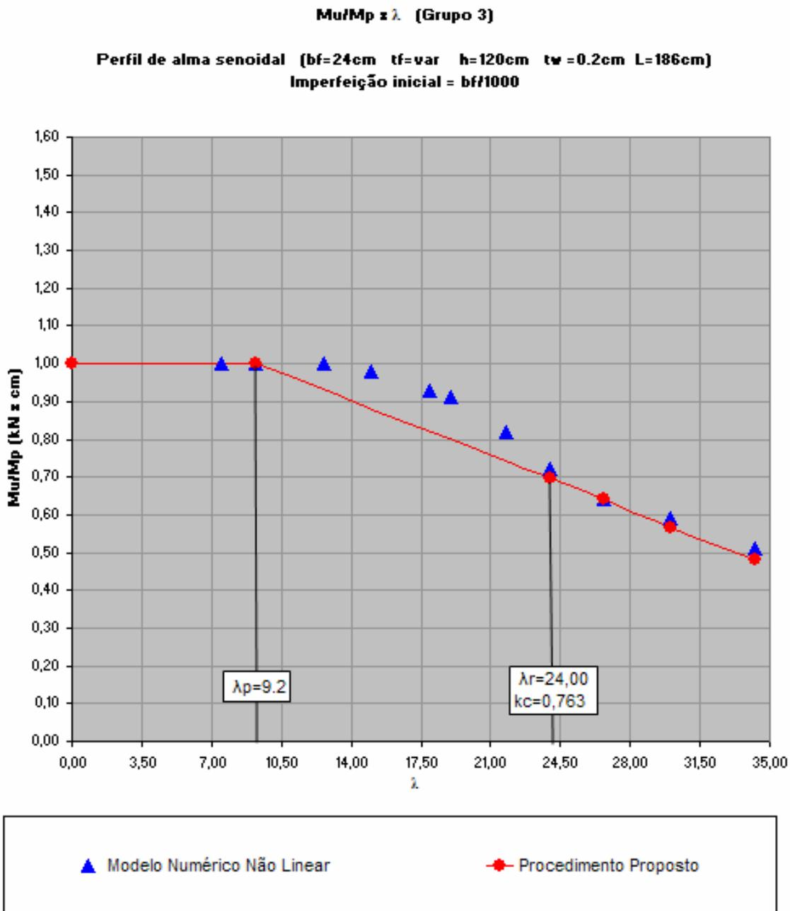
Figura 6.3 - Curva do procedimento proposto e resultados da análise não-linear considerando a semi-largura das mesa na determinação de sua esbeltez (Grupo 3)
