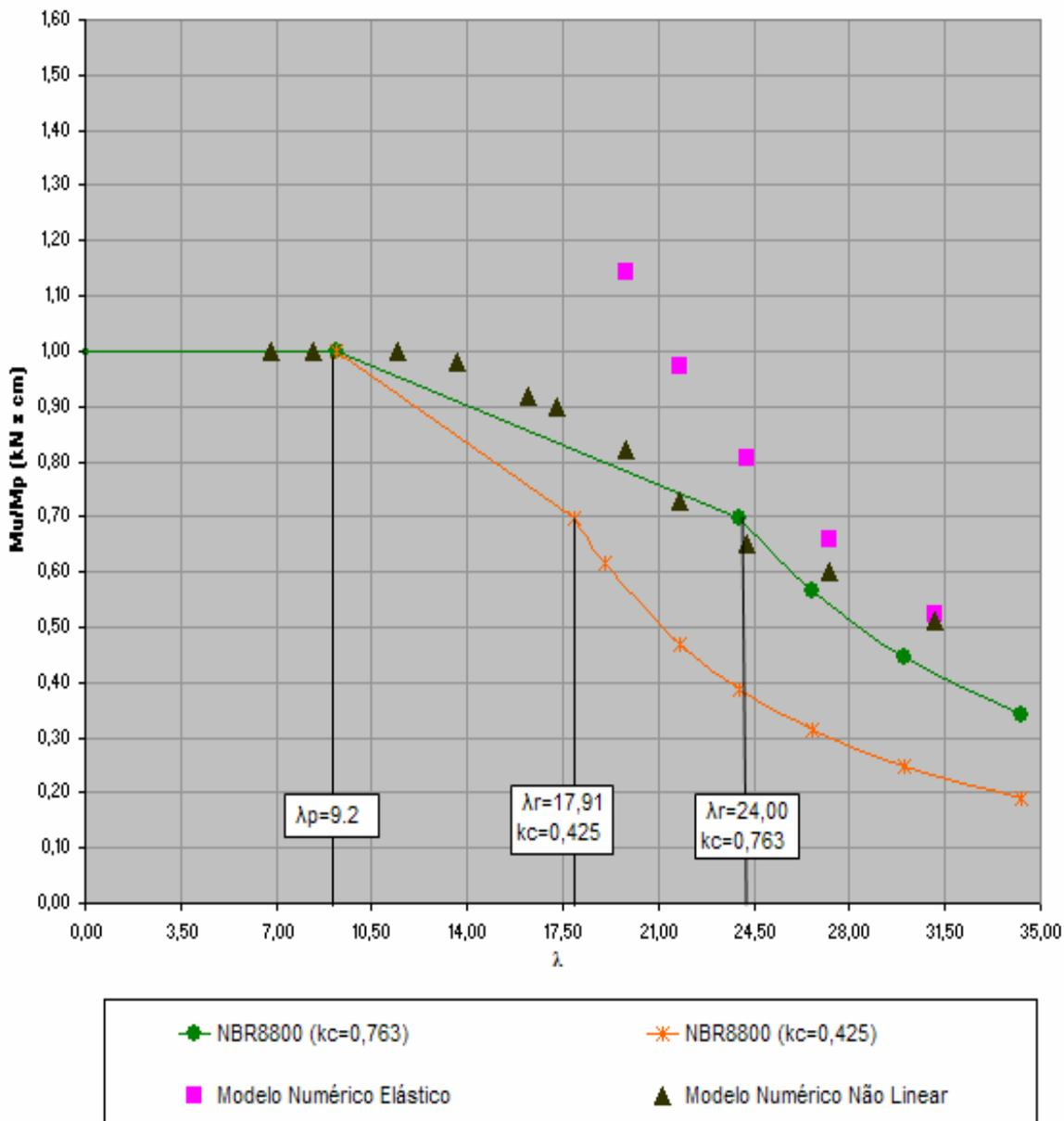
FIGURA 5.8 - Curvas  $M_u/M_p$  x  $\lambda$  da NBR 8800 e resultados numéricos considerando, na determinação da esbeltez da mesa, a largura reduzida proposta pela Zeman (Grupo 2)
