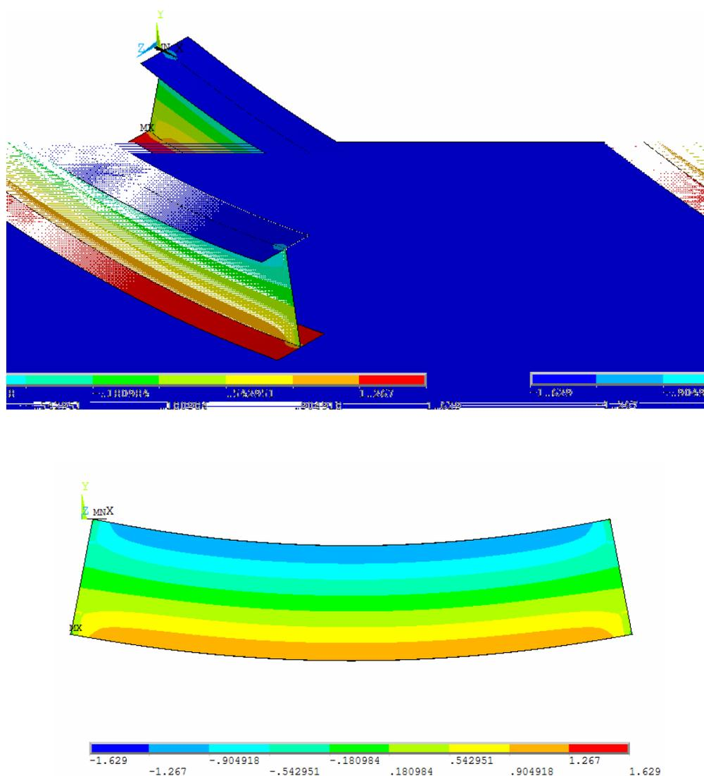
FIGURA 4.9 - Análise elástica estática do modelo em exemplo, carregado com o momento de referência (perspectiva e vista lateral)
