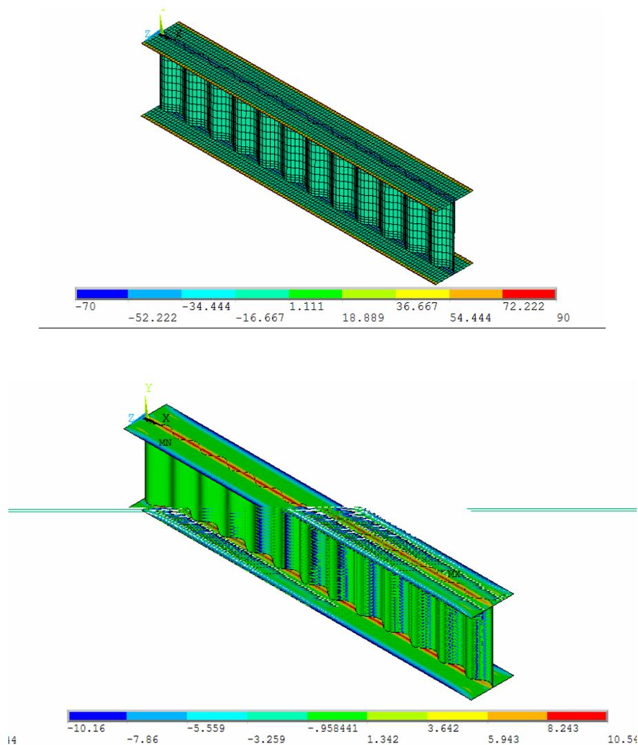
FIGURA 4.23 - Carregamento por variação de temperatura e nível de tensões residuais do modelo em exemplo
