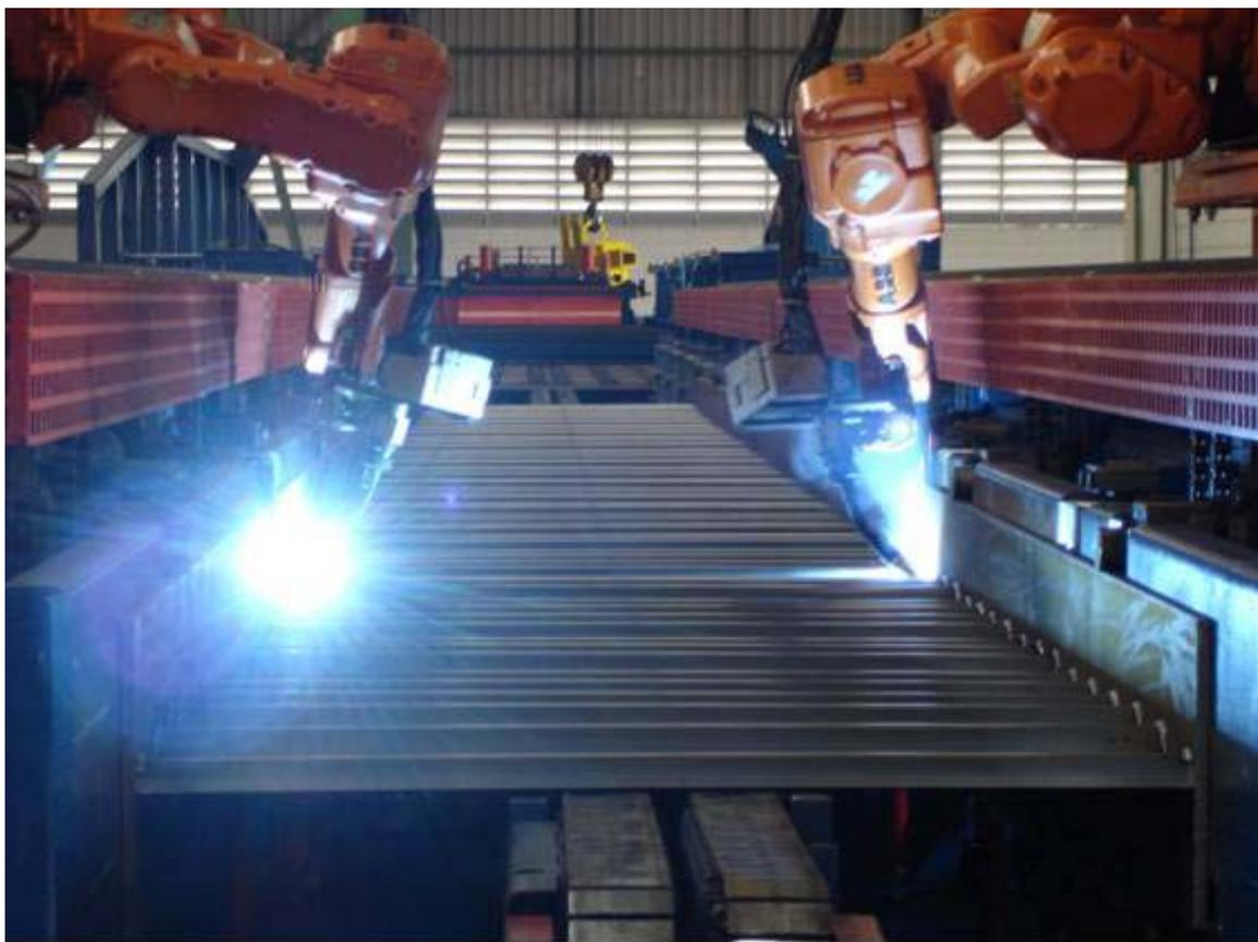
FIGURA 1.7 - Soldagem do perfil I de alma senoidal
