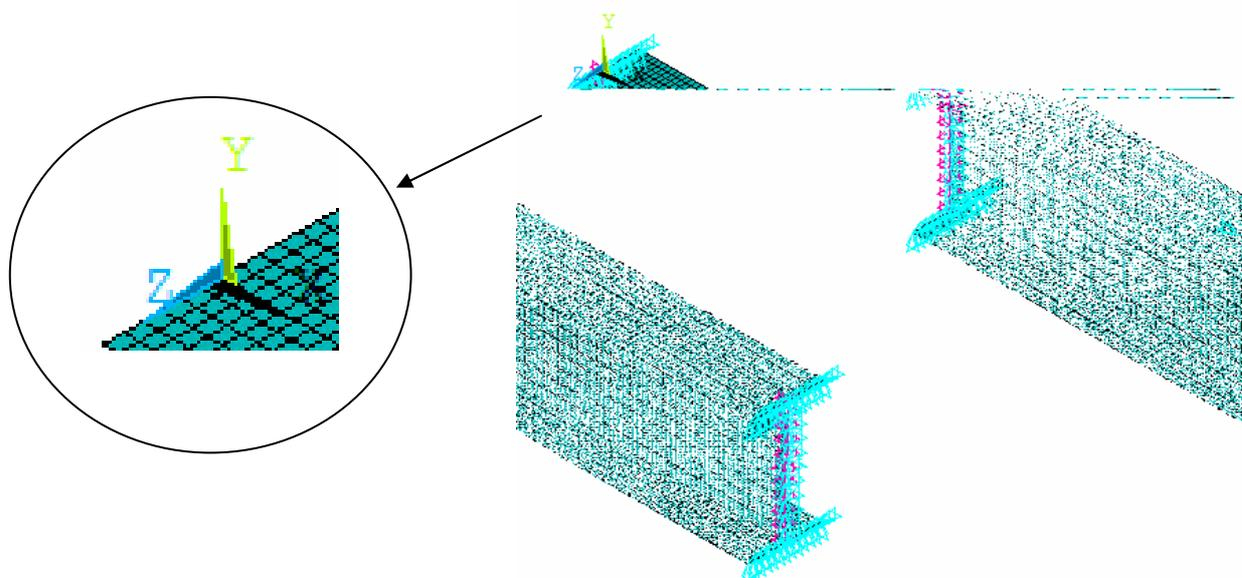
FIGURA 4.8 - Condições de contorno do modelo em exemplo
