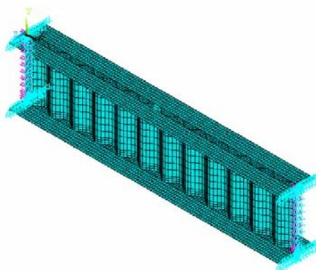
FIGURA 4.20 - Condições de contorno do modelo em exemplo
