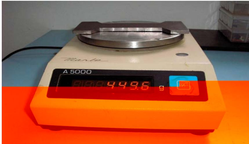
FIGURA 4.3- Pesagem das chapas em formato de “halter”.
