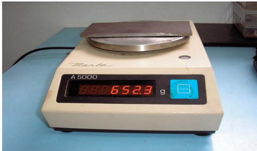
FIGURA 4.4- Pesagem das chapas em formato retangular.
