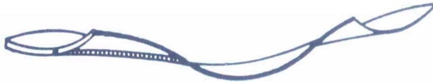
FIGURA 3.5- Distorção devido à instabilidade (AWS, 1987).
