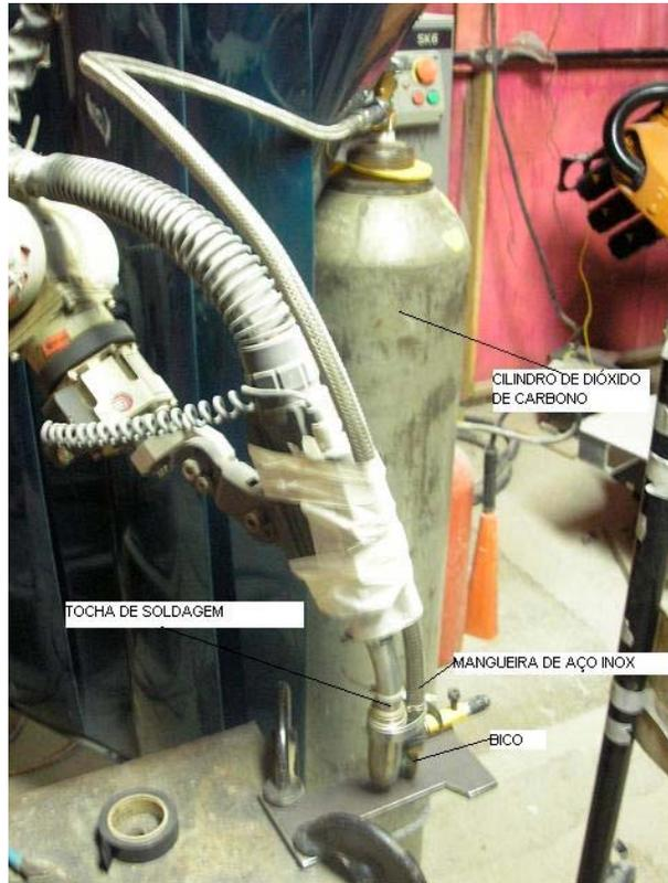
FIGURA 4.8 - Montagem experimental dos testes 21 a 30.
