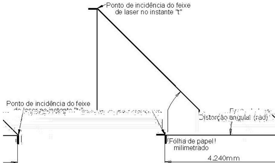
FIGURA 4.10- Relações trigonométricas para obtenção da distorção angular.
