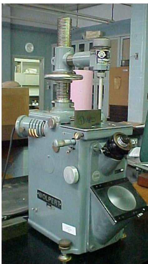
**Figura 33 – Equipamento de medição de microdureza**
